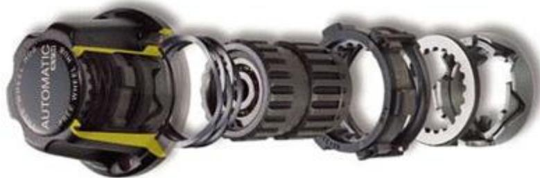
Abbildung 3.3: Manuell schaltbarer Nabenfrelauf [20]
