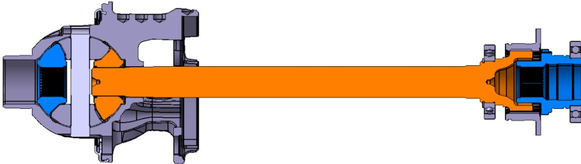
Abbildung 3.6: Entkopplung an einer Differenzialabtriebswelle
