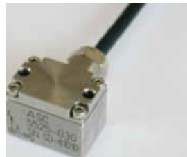
Abbildung 10 dreiachsiger Beschleunigungssensor (ASC 5525) [10]
