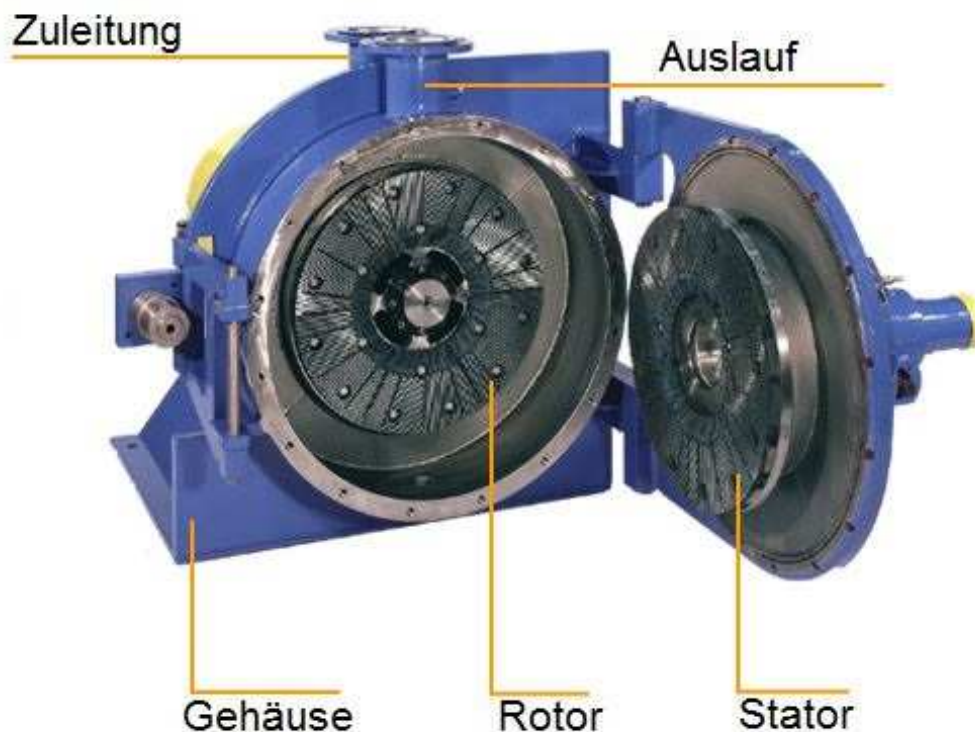
Abbildung 17: Andritz TwinFlo-Refiner mit geöffnetem Gehäuse 21
