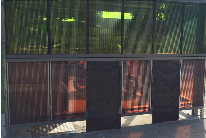
Abbildung 3.20: Versuchsaufbau mit zwei vollkommen verschatteten DSSCs
