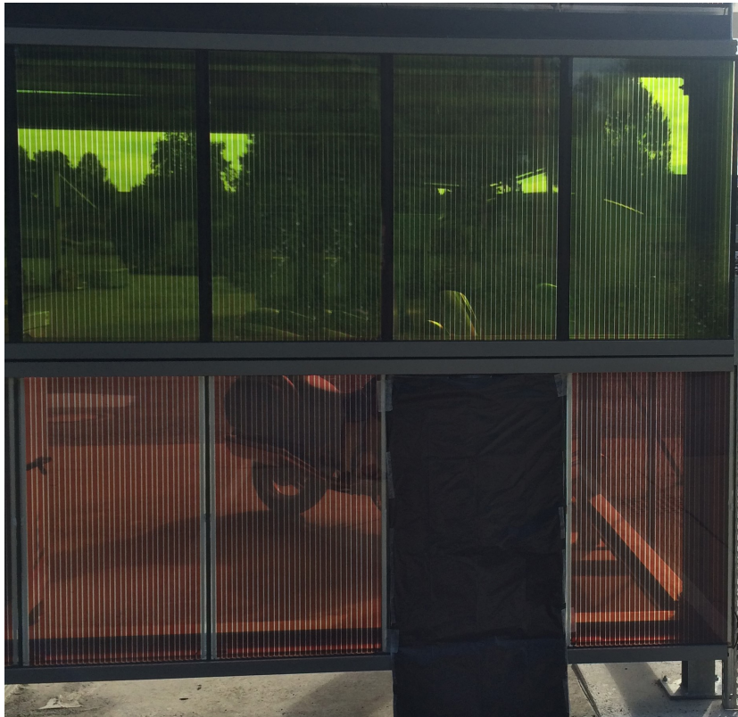
Abbildung 3.18: Versuchsaufbau zur Simulation einer vollkommen einseitig verschatteten DSSC
