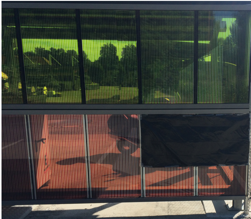
Abbildung 3.22: Abbildung des Versuchs zwei DSSCs halb zu beschatten
