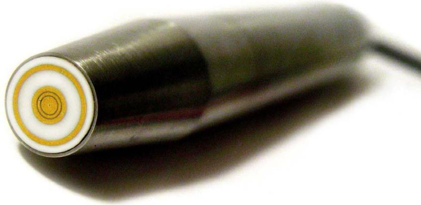
Abbildung 1.8.: Oberflächenelektroden [20]
