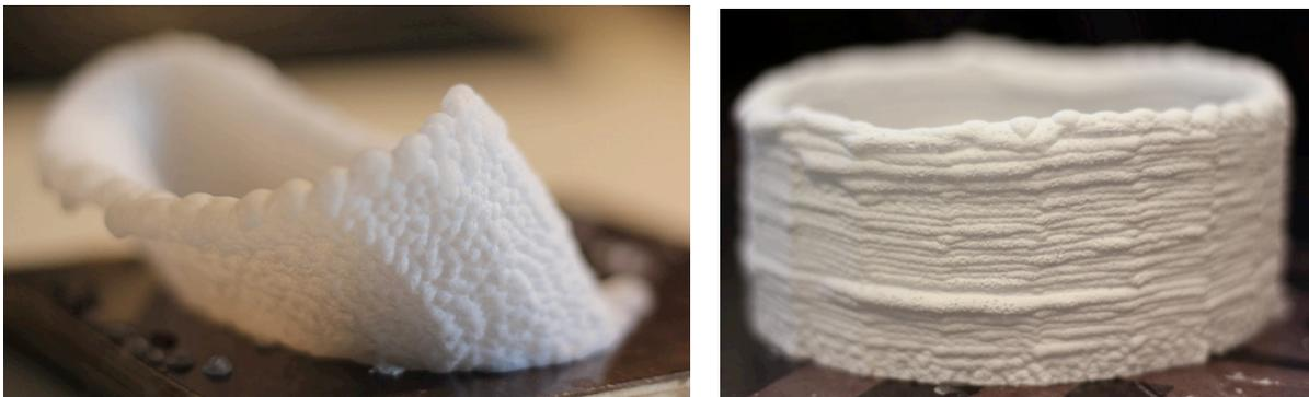
Abb. 3-14: Im linken Bild ist die tropfenartige Struktur und im rechten Bild schichtenartige Struktur dargestellt. (Eigene Darstellung)
