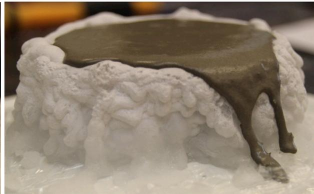
Abb. 3-27: ausgegossener Natriumacetat-Trihydrat Zylinder (Eigene Darstellung)
