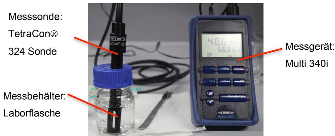
Abb. 3-5: Messaufbau zur Ermittlung des Leitwerts (Eigene Darstellung)
