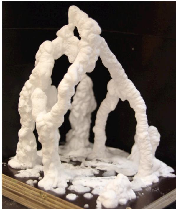
Abb. 3-24: Überhängende Struktur aus Natriumacetat-Trihydrat durch manuell geführte Düse erzeugt. (Eigene Darstellung)
