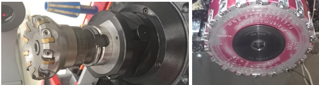
Abbildung 72: links: Fräser für Stahlguss; rechts: Fräser für Aluminium
