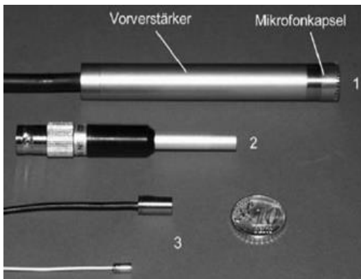
Abbildung 22: 1: Kondensatormikrofon 2: Elektretmikrofon 3: Mini-Elektretmikrofone (Kollmann et al. 2006, p. 186)
