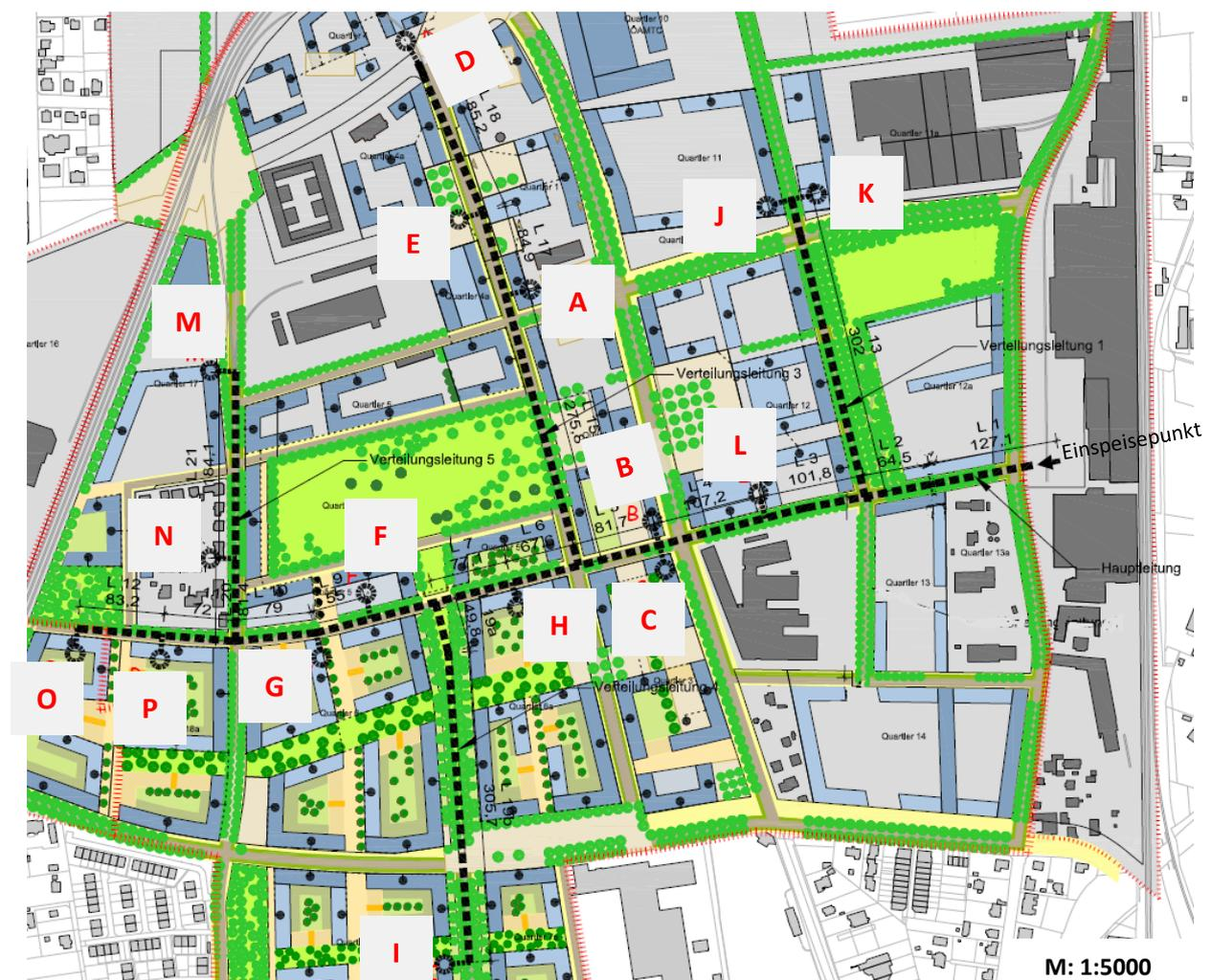
Abbildung 4-35: Geplantes Primärnetz ECR (Eigendarstellung, Quelle: Rainer, et al., 2014)
