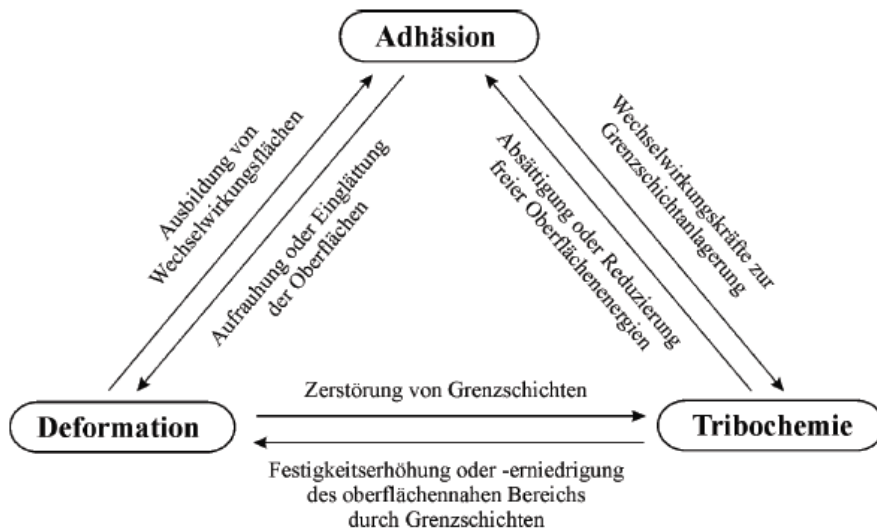
Abbildung 8: Zusammenhang zwischen den Festkörperreibungsmechanismen [5] S.78
