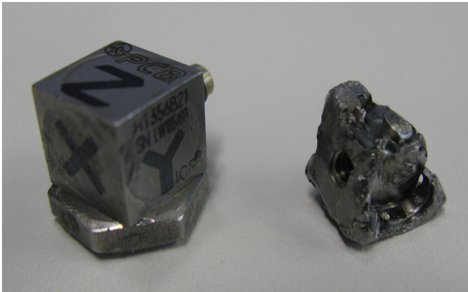
Bild 5.11: links: einer der Schwingungssensoren die an den Hauptlagerschalen angebracht waren, rechts: der Schwingungssensor der sich gelöst hat
