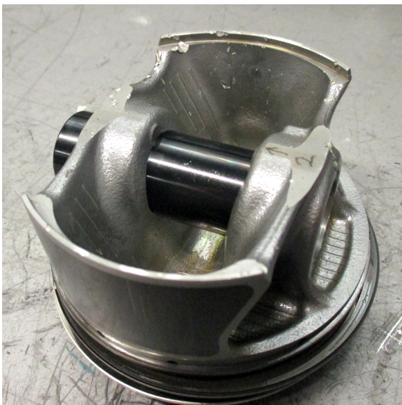
Bild 5.12: Der von dem losen Sensor beschädigte Kolben
