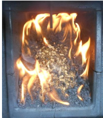
Abbildung 50: Bild der unzureichenden Verkohlung über den Querschnitt der Verkohlungskammer bei der Versuchsdurchführung mit einem Gemisch aus pelletierten Biertrebern und Holzpellets
