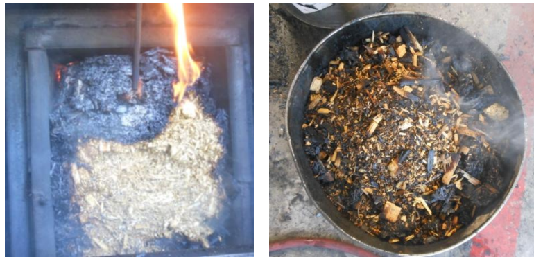
Abbildung 44: Bilder zur unvollständigen Verkohlung bei der Versuchsdurchführung mit dem Gemisch aus Holzhackgut und losem Biertreber
