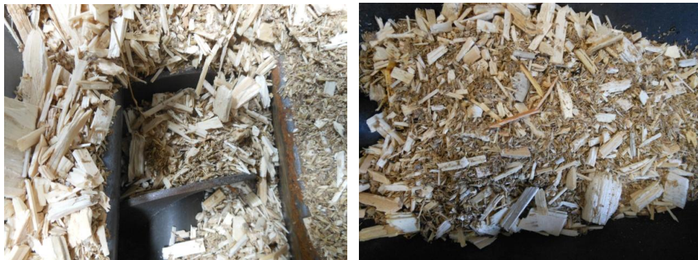
Abbildung 41: Gemisch aus rindenlosem Holzhackgut und sonnengetrockneten losem Biertreber
