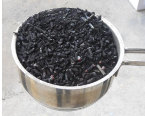
Abbildung 19: Erzeugte Pflanzenkohle aus Holzpellets beim ersten Vorversuch mit Pellets
