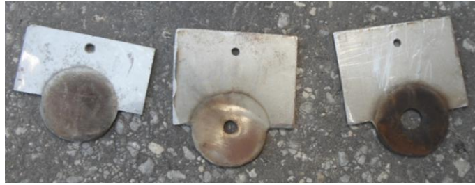
Abbildung 12: Blenden für die Regelung der Luftzufuhr des Prototyp BK1
