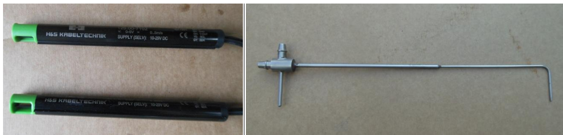
Abbildung 26: Eingesetzte Hitzdrahtanemometer und Prandtlsonde
