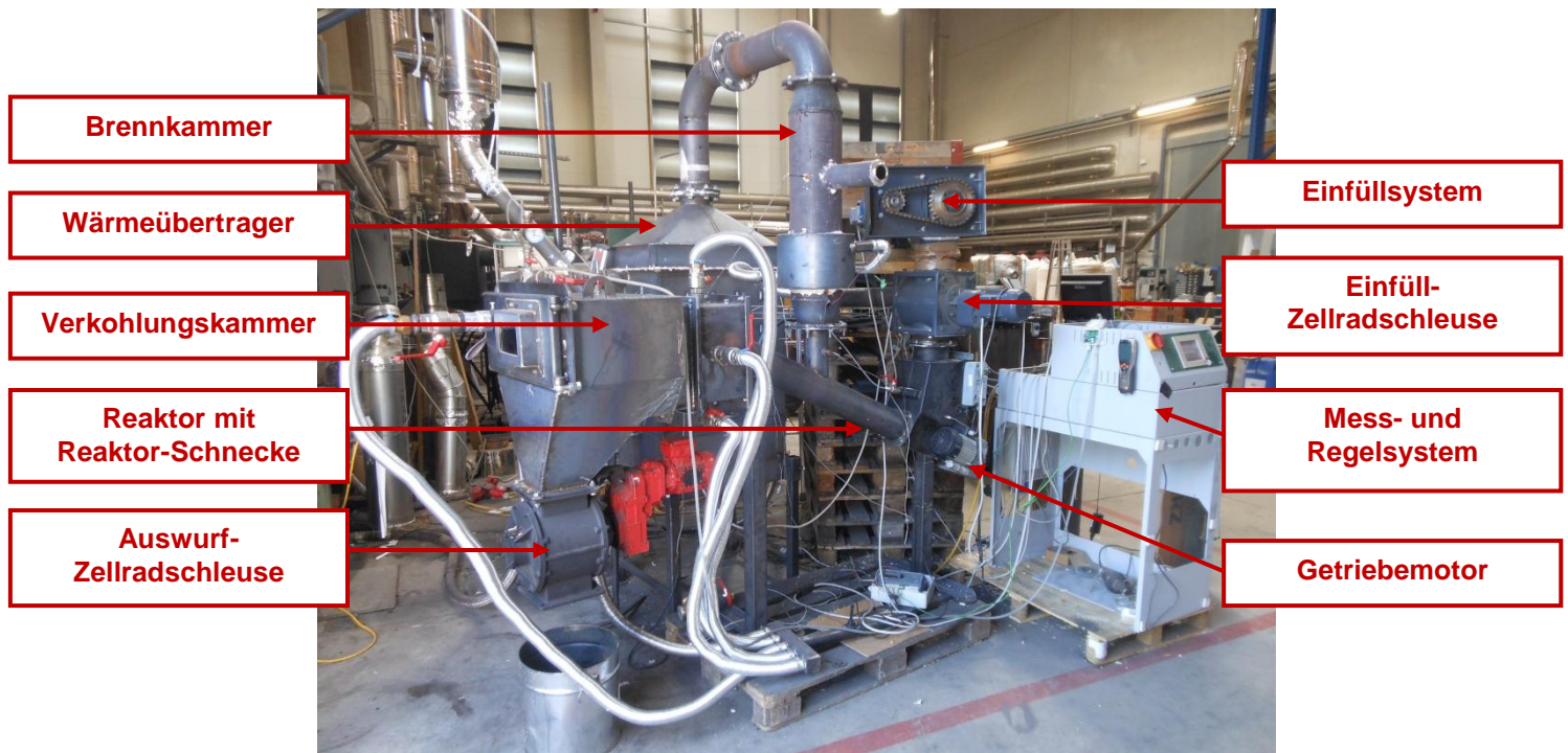
Abbildung 21: Versuchsaufbau mit dem PH1-Reaktor
