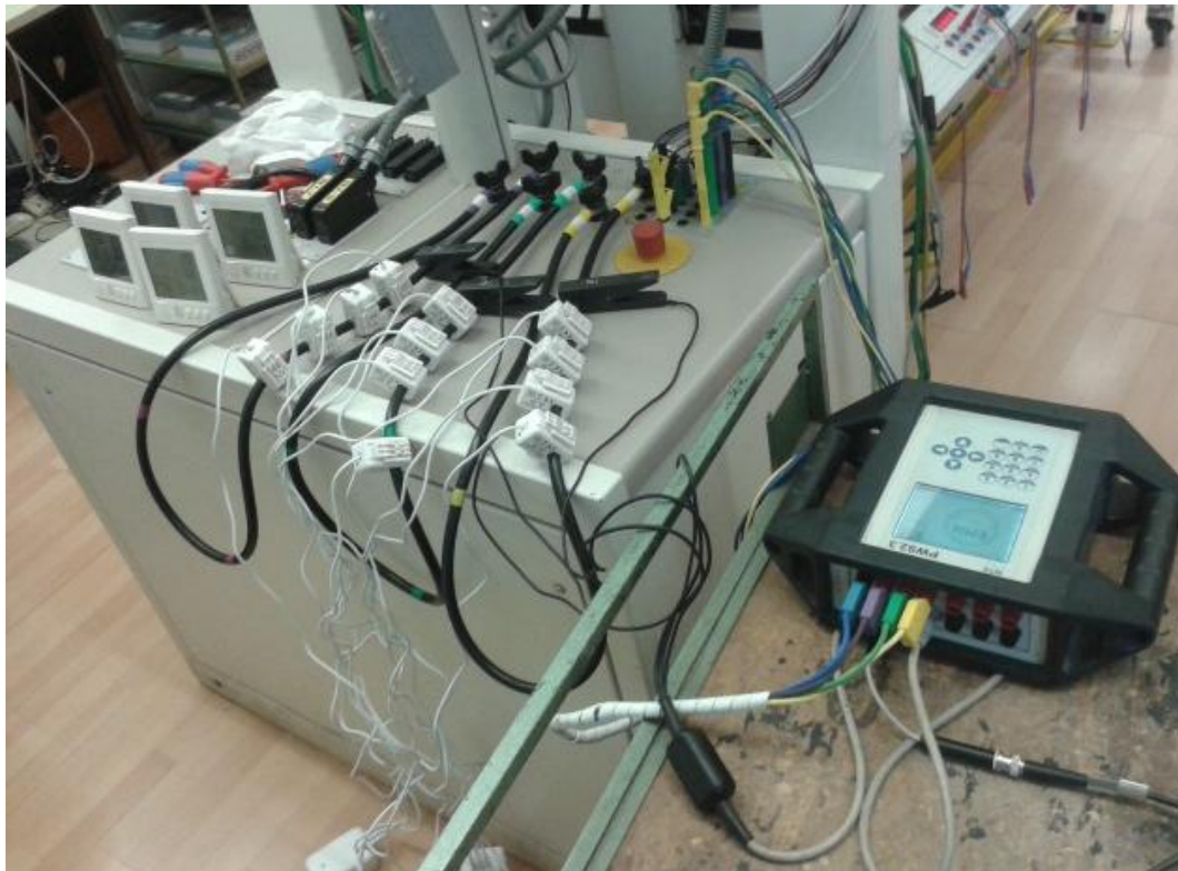
Abbildung 4: Prüfaufbau Messgenauigkeit OWL Smart Meter
