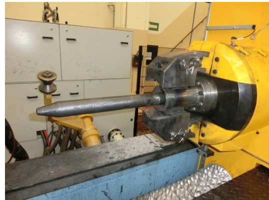
Bild 91: Schmiedehämmer und einstufige Dornstange DB (links), Manipulator mit Dornstange D (rechts)
