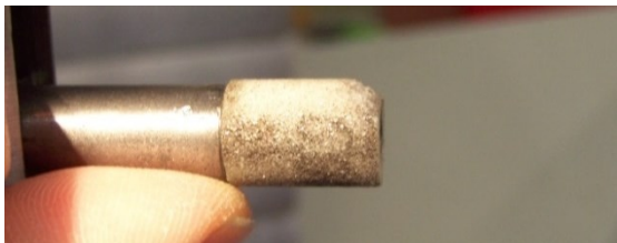
Bild 64: Verschleißzustand nach dem 2. Durchlauf Seitenansicht
