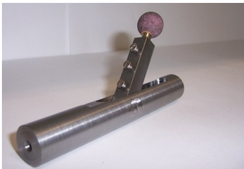
Bild 68: Flihkraftauslenkungswerkzeug mit kugelförmigem Schleifstift
