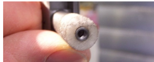
Bild 65: Verschleißzustand nach dem 2. Durchlauf Frontalansicht
