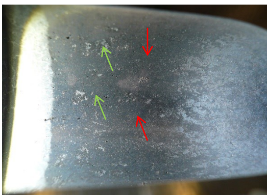
Bild 110: Verzunderung der rechten Wellenseite (Welle Nr.404)
