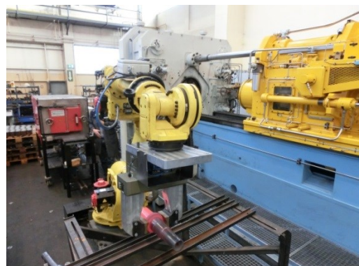
Bild 102: Greifen des fertigen Schmiedeteils durch den Roboter (links) und Ablegen auf die Ablagevorrichtung (rechts) zur Luftabkühlung
