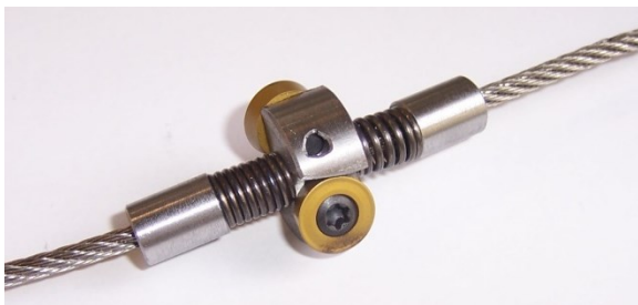
Bild 47: Stahlseil mit Werkzeughalter, bestückt mit zwei Hartmetallschneidplatten
