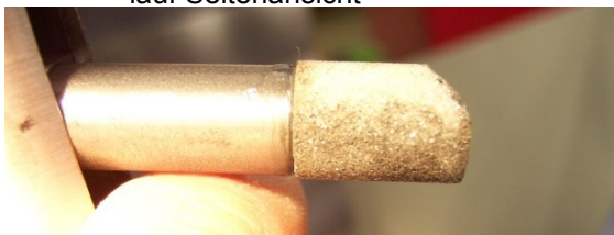
Bild 66: Verschleißzustand nach dem 3. Durchlauf Seitenansicht
