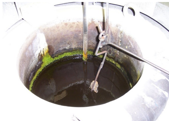
Bild 89: Einsenken der Getriebehohlwelle zur Kolene 4-Behandlung in das flüssige Salzbad (480°C).
