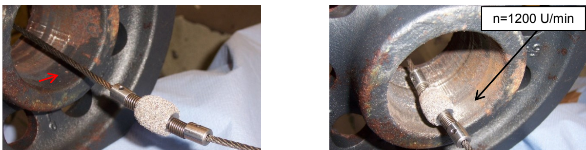
Bild 50: Schleifmittelbesetzte Schleiftonne (links) und unbearbeiteter Flächenbereich (roter Pfeil); Bearbeitungsergebnis mit einer Drehzahl n=1200 U/min (rechts)
