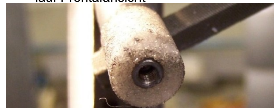
Bild 67: Verschleißzustand nach dem 3. Durchlauf Frontalansicht
