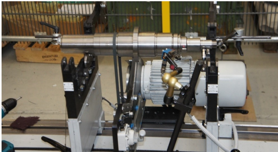
Bild 138 : Auswuchteinrichtung von der Fa Hoffmann zur Unwuchtmessung von Wellen
