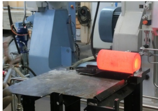
Bild 98: Herausheben des erwärmten Rohteils aus dem Ofen (links) und Ablegen auf den Tisch (rechts)
