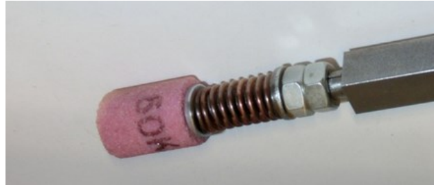
Bild 71: Vorderer Teil des Werkzeuges mit eingespanntem Schleifstift und Feder für die Einstellung des Verdrehwiderstandes
