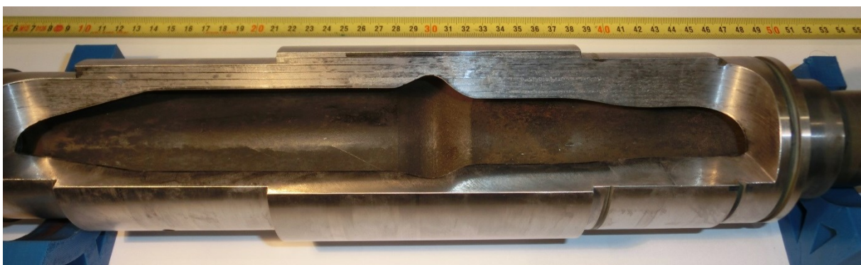
Bild 133: Übersicht des Hohlräume der Welle 436 nach der Entzunderung mit dem Kolene-4-Verfahren bei einer Salzbadtemperatur von 320 °C
