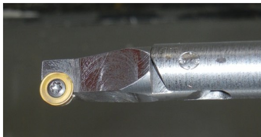
Bild 59: Optimiertes Fliehkräftauslenkungswerkzeug mit Schneidplatten (Version 2)
