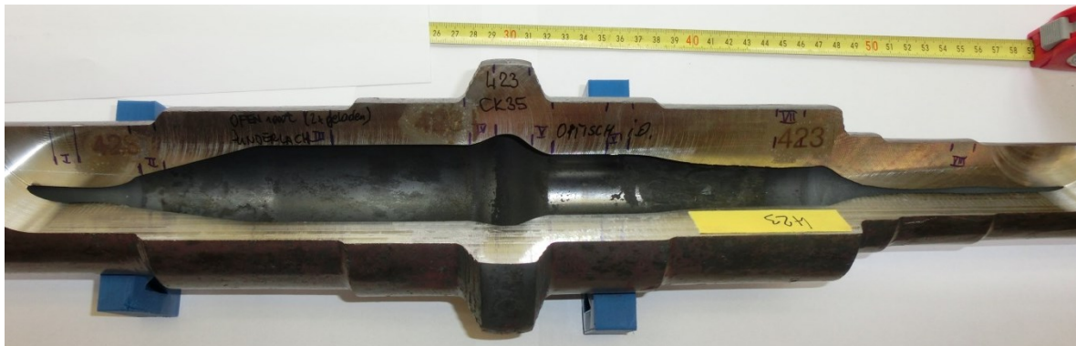
Bild 123: Übersicht des Hohlraumes der Welle Nr. 423 (aus Ck35 gefertigt). Die Sichtprüfung zeigt keine unzulässige Auffälligkeit
