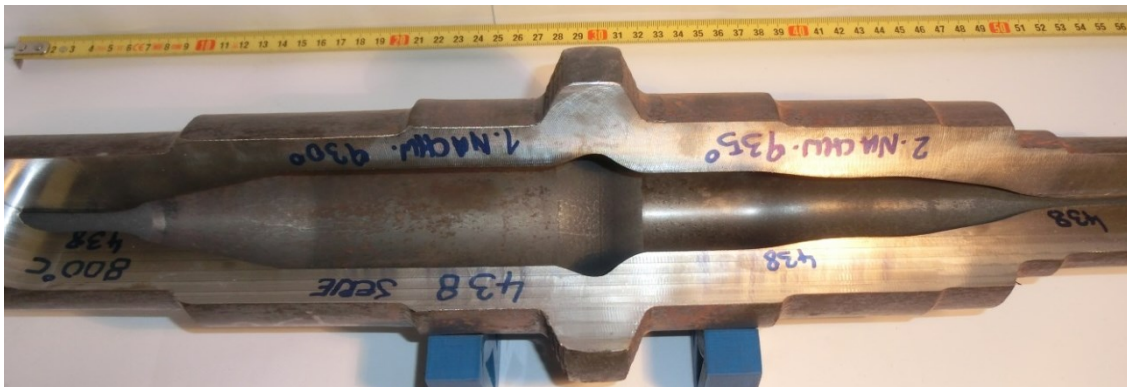
Bild 125: Gesamtübersicht des Hohlraumes für die Sichtprüfung der geschmiedeten Welle 438 der Serie 6
