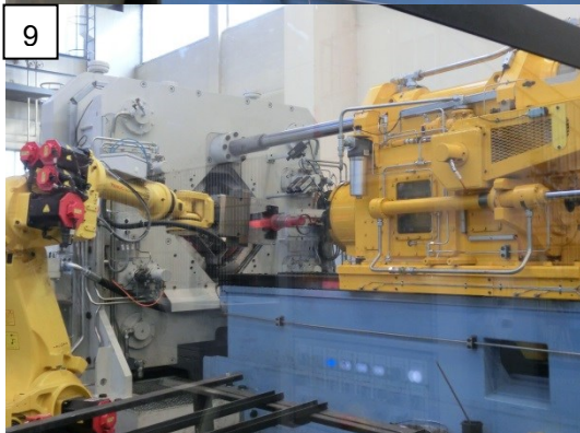
Bild 92: Versuchsablauf beim Schmieden der Hohlwellen der Serie 4
