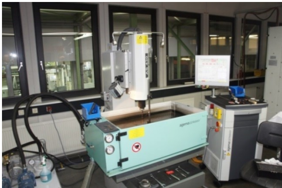
Bild 160: Erodiermaschinen AgemaGermany AS430 mit ins Dielektrikum eingetauchtem Bauteil (Bild links) und Mandra BT – 2NC ATC mit ins Vierbackenspannfutter eingespanntem Dummy-Werkstück
