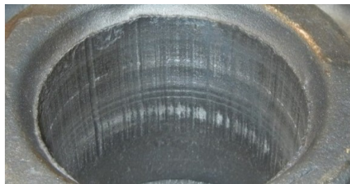
Bild 54: Bearbeitungsergebnis des Fliehkraftauslenkungswerkzeuges mit Borsten
