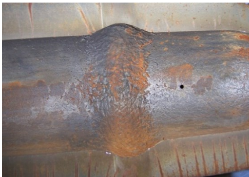
Bild 88: Ergebnis der Kolene 4-Behandlung einer Getriebehohlwelle: Bild links zeigt den Zustand vor der Behandlung mit Zunder und Rost auf der Oberfläche; Bild rechts zeigt die mit der Behandlung erzielte, komplett zunder- sowie rostfreie Oberfläche
