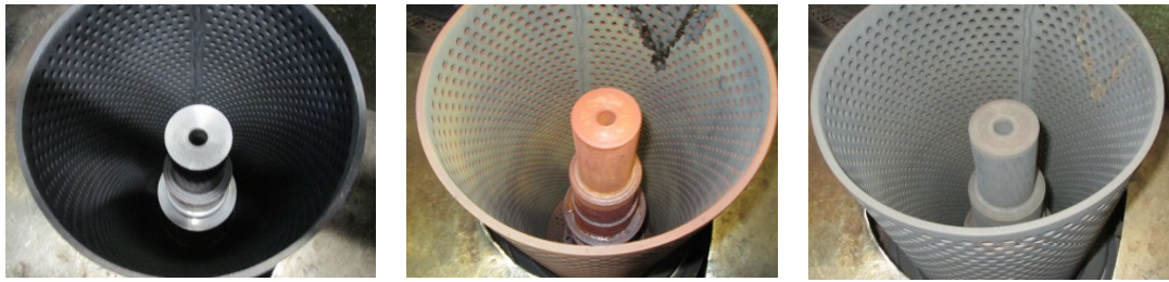
Bild 158: links: Getriebewelle vor der thermischen Behandlung im Gitterkorb; Mitte: Aussehen der Welle nach dem Oxidationsschuss; rechts: Aussehen der Welle nach dem Reduktionsschuss (rechts)
