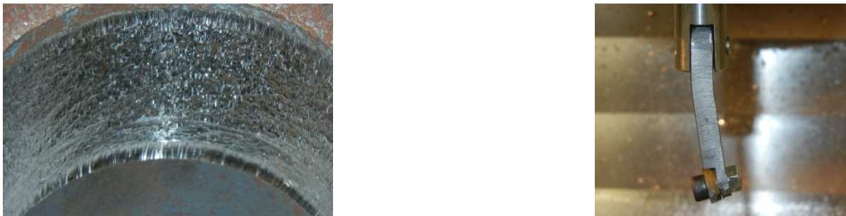
Bild 58: Ergebnisse des 2. Durchlaufes: Oberfläche des Versuchsträgers nach dem Versuch (links) und Zustand des Werkzeuges nach dem Bearbeitungsversuch (rechts)
