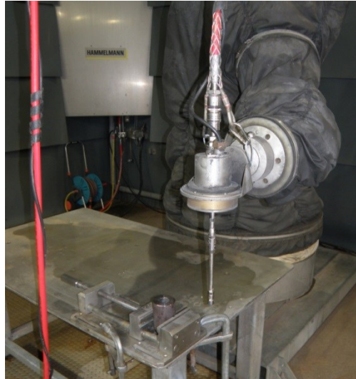
Bild 84: Versuchsstand bei Firma Hammelmann für Bearbeitungsversuche mit dem Hochdruckwasserstrahlen. Ein Versuchsträger ist am Aufspanntisch im Schraubstock eingespannt. Die Führung der rotierenden Lanze erfolgt mit Hilfe eines Knickarmroboters.
