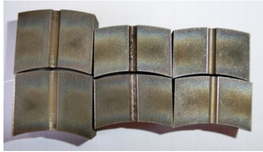
Bild 163: Aufgeschnittene Bohrungen zur Überprüfung der Rauheit der Bohrungen 4 (rechts), 5 (Mitte), 6 (links)
