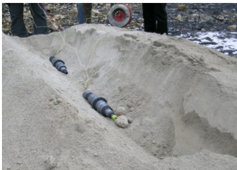
Bild 43: Eingelegte Hohlwellen im ausgehobenen Sandhaufen (links) und eingegrabene Hohlwellen mit Baggerschaufel abgedeckt (rechts)
