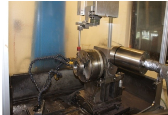
Bild 160: Erodiermaschinen AgemaGermany AS430 mit ins Dielektrikum eingetauchtem Bauteil (Bild links) und Mandra BT – 2NC ATC mit ins Vierbackenspannfutter eingespanntem Dummy-Werkstück
