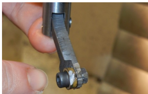
Bild 56: Verschlissene Wendeschneidplatte des Auslenkungswerkzeuges
