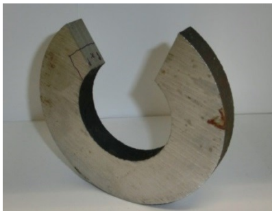
Bild 36: Schleudergussscheibe mit eingezeichneter Markierung zum Herausschneiden eines Segments (links) und herausgeschnittenes Segment für metallografische Untersuchungen zur Bestimmung der Zunderdicke (rechts).
