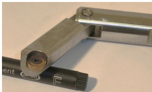
Bild 82: Kein Verschleiß der Wendeschneidplatte nach den Bearbeitungsversuchen 1 bis 8
