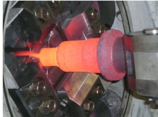
Bild 101: Induktive Erwärmung (links) und Schmieden der zweiten Stufe mit dem DB-Dorn (rechts)
