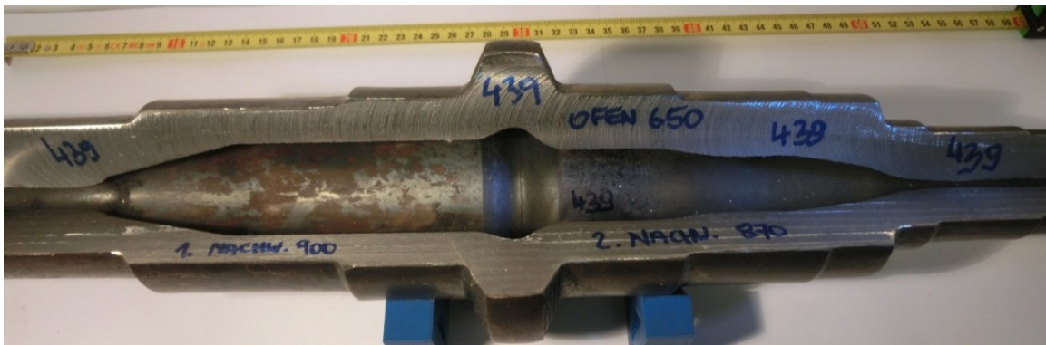
Bild 127: Übersicht des Bearbeitungsergebnisses der Welle 439; mit der Sichtprüfung sind keine Fehlstellen erkennbar
