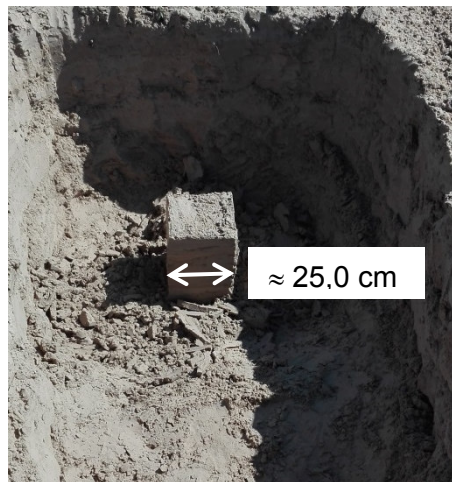
Abb. 54 Ausarbeitung des Probekörpers
