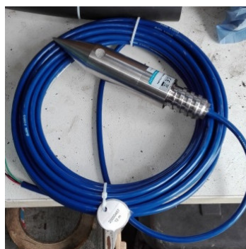
Abb. 44 Porenwasserdruckgeber Firma Geokon
