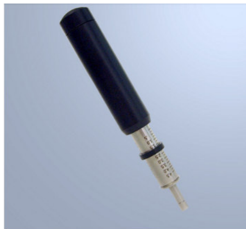
Abb. 51 Taschenpenetrometer (www.geotechnik-shop.de, abgerufen am 13.02.2017)
