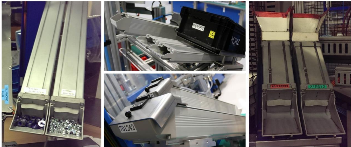
Abb. 17: Übersicht der Bereitstellung von Schüttgut an den Modulen der Montageanlagen der tk steering
