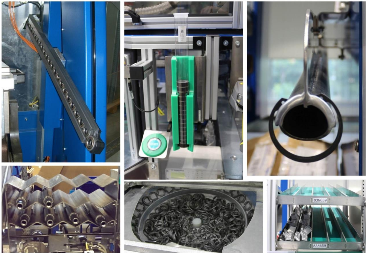
Abb. 18: Übersicht der Vereinzelung von Bauteilen an den Modulen der Montageanlagen der tk steering
