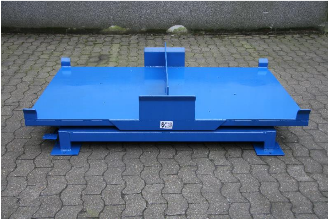
Abb. 31: Beispiel eines Drehtisches zur Bereitstellung von zwei GLT [MUE17]
