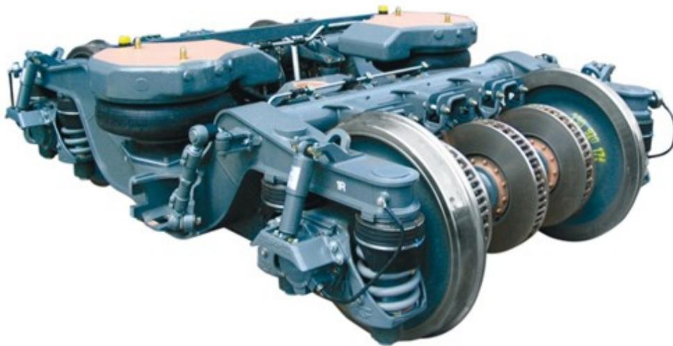
*Abbildung 1: Fahrwerk SF400 (Quelle: Siemens Produktportfolio)*
