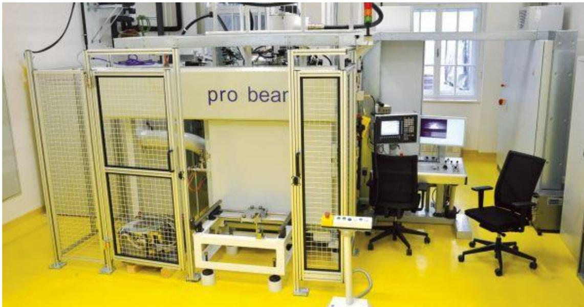
Abbildung 3.6 Elektronenstrahlanlage TU Graz [25]
