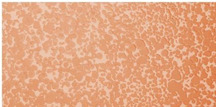
Abbildung 2.9 MoCu-Verbundwerkstoff mit 30 % OF-Kupfer [2]
