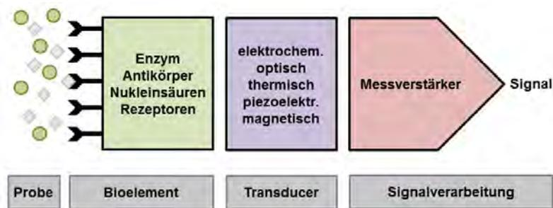
Abbildung 4: Aufbau eines Biosensors
