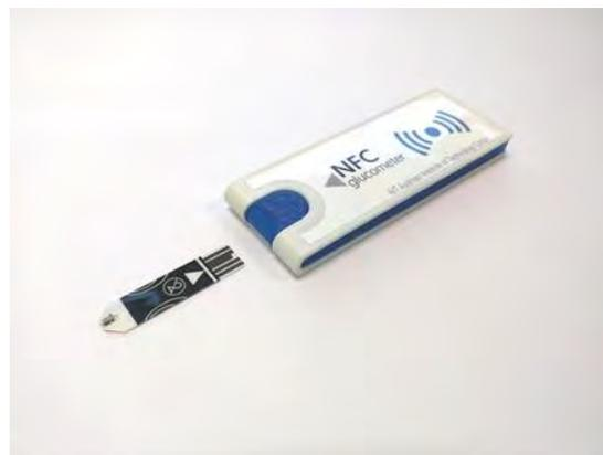
(c) NFC-Glucometer Prototyp
