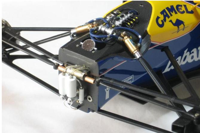
Abbildung 2.12: aktives Fahrwerk am Williams FW14B [15]
