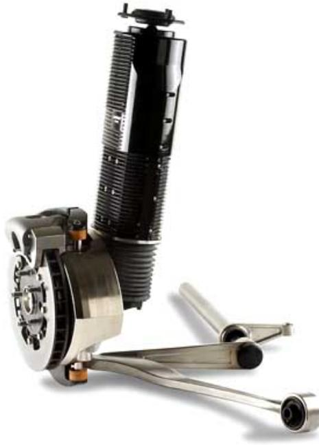
Abbildung 2.10: Bose-Fahrwerk [12]
