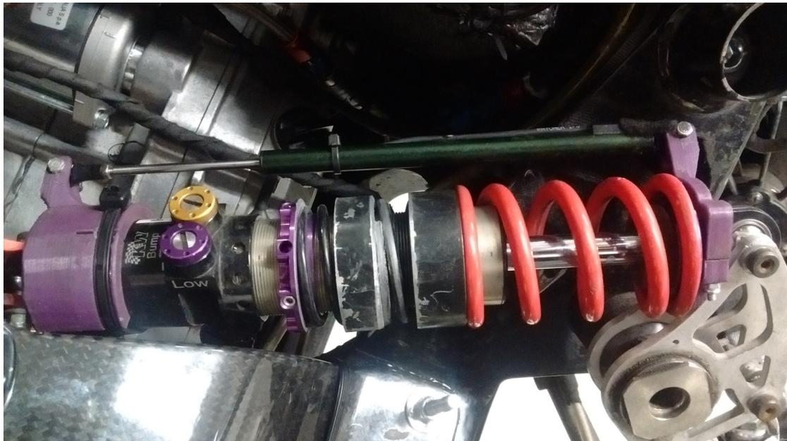
Abbildung 3.1: Linearpotentiometer am Federbein des TANKIA 2016
