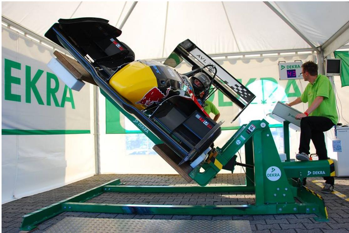
Abbildung 1.2: TU Graz Racing Team beim Tilt Test in Deutschland 2014 [5]
