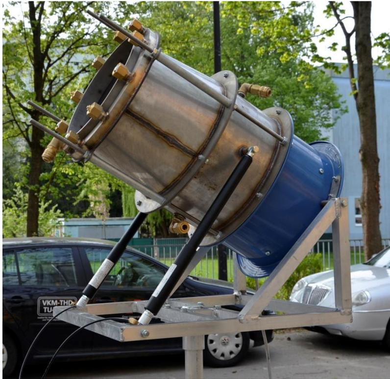
Abbildung 4-28: Schneekanone - Abwurfwinkel  $\sim 30^\circ$
