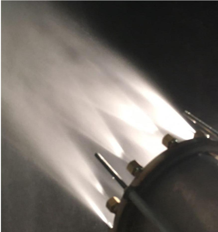
Abbildung 5-8: Sprühbild mit 10 Wasserdüsen
