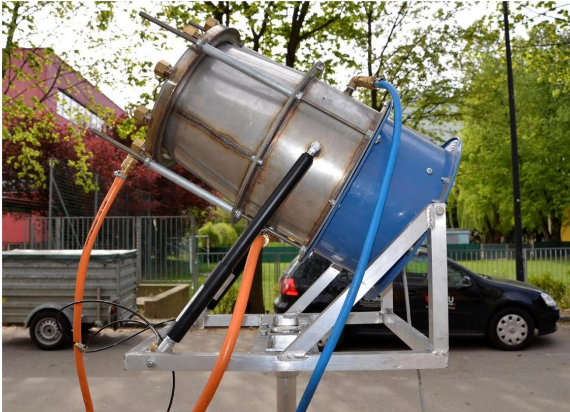
Abbildung 4-26: Schneekanonenkörper und Aufhängung angeschlossen
