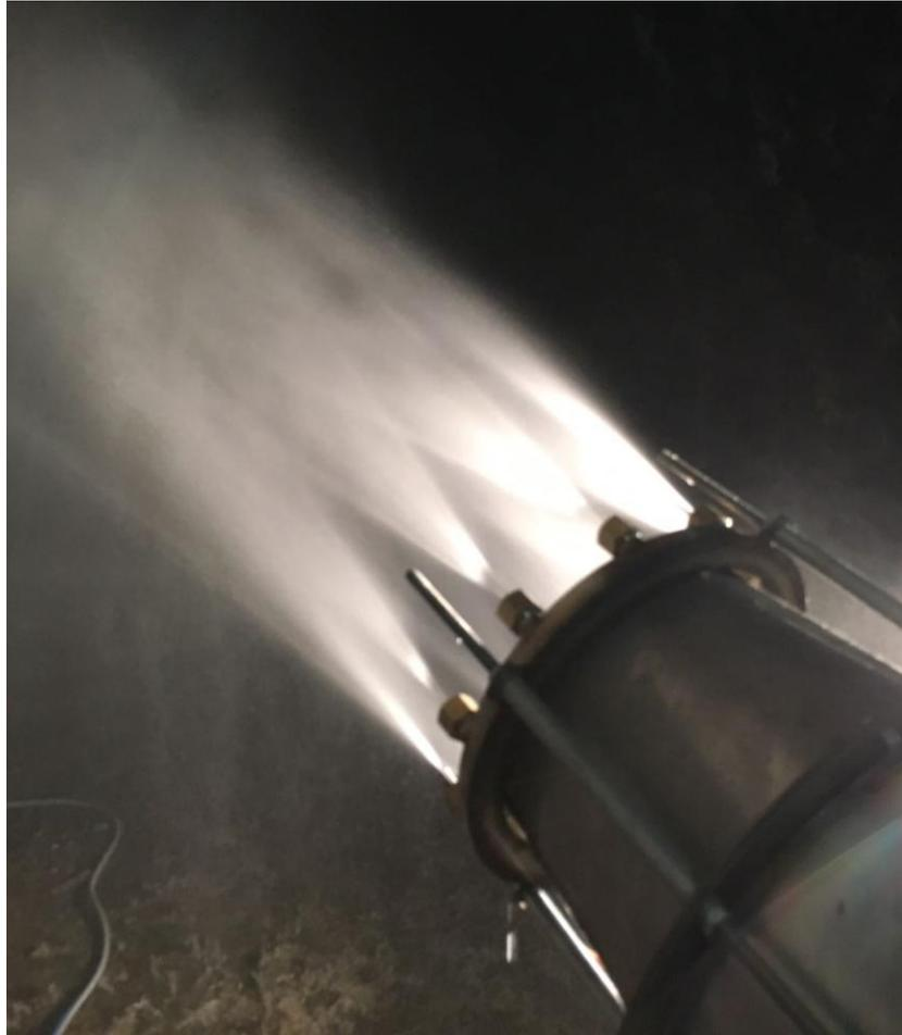
Abbildung 5-2: Sprühbild Wasserdüsen
