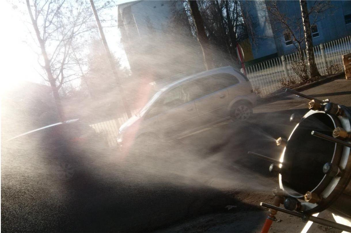
Abbildung 5-9: Sprühbild mit 5 Wasserdüsen
