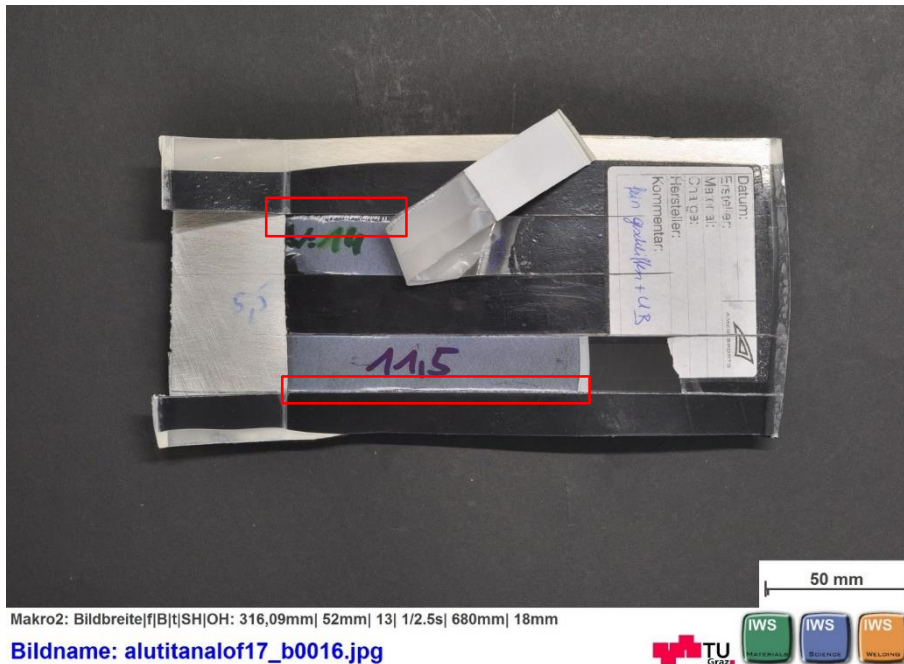
Abbildung 3-29: Bruchfläche Titanal fein geschliffen + UB oberflächenseitig
