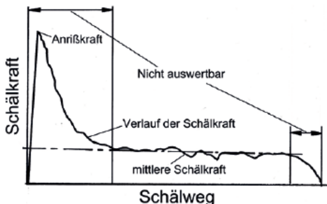
Abbildung 3-25: Verlauf der Schälkraft über den Schälweg [8]
