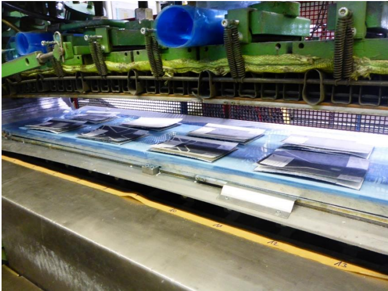
Abbildung 3-22: In die Presse eingelegte Proben vor dem Pressvorgang
