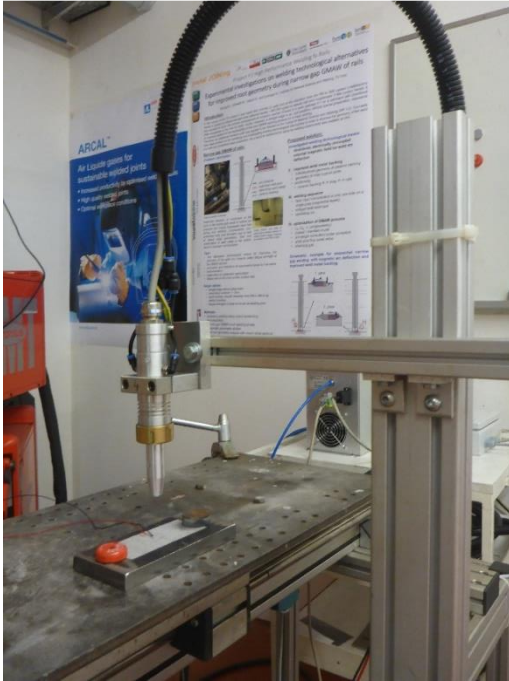
Abbildung 3-11: Messaufbau der MCP-Aktivierung (IMAT TU Graz)
