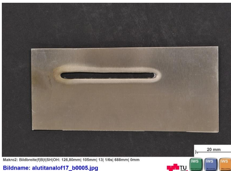
Abbildung 6-1: Zerstörung des Substrates aufgrund falscher Aktivierungsparameter (zu hoher Energieeintrag)
