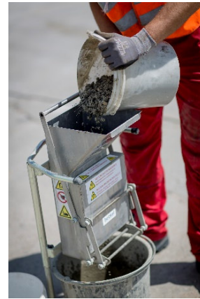
Abb. 6-4 Aussonderung der Fasern aus dem Frischbeton zur Bestimmung des Stahlfasergehaltes
