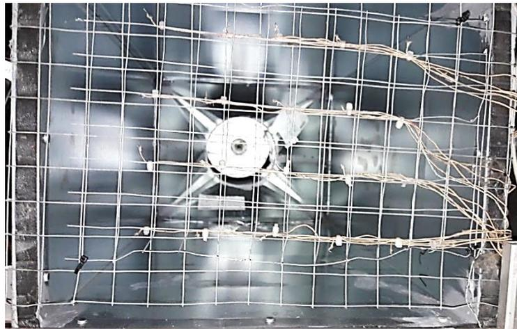
Abbildung 5-4: Thermoelemente-Messgitter nach Verdampfer, mit Blick in Strömungsrichtung
