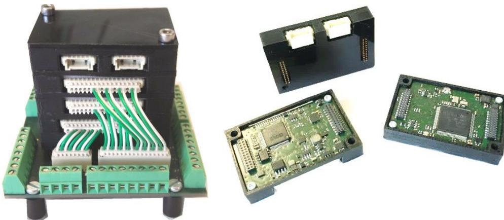
*Abbildung 3-37: Modular aufgebaute Miniatur-Messplattform "VifDAQ" (ViF 2017)*
