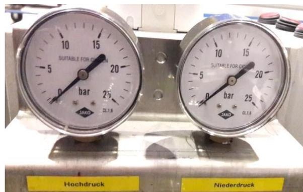
Abbildung 3-33: Analoge Zeigermanometer als optische Kontrolle des elektronischen Messsystems
