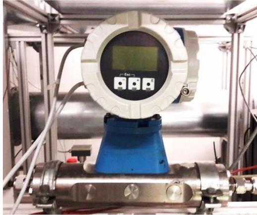
Abbildung 5-7: Verwendeter Coriolis-Massendurchflussmesser „Promass 83“
