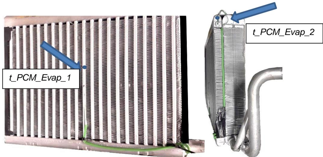
Abbildung 5-5: Platzierung der Thermoelemente direkt am und im PCM-Speicherverdampfer ( $t_{PCM\_Evap\_1}$ ,  $t_{PCM\_Evap\_2}$ )
