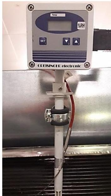
Abbildung 5-10: Verwendeter Luftfeuchtigkeitssensor, speziell für hohe Feuchtigkeit geeignet
