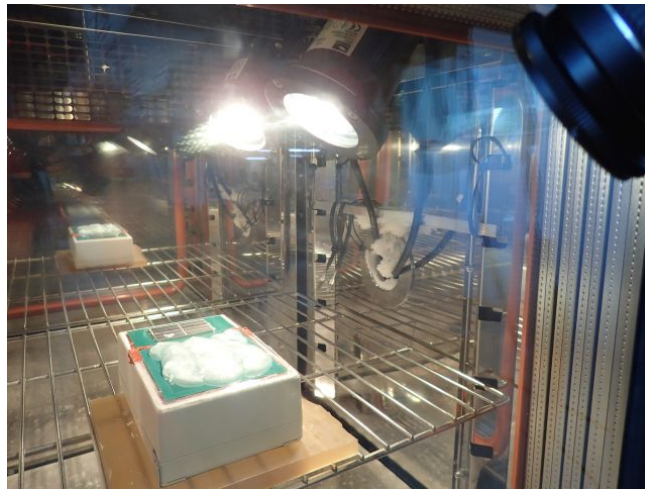
Abbildung 4.15: Versuchsaufbau. Gerät in Klimakammer, Elektrodenfläche bedeckt mit Eisfläche.
