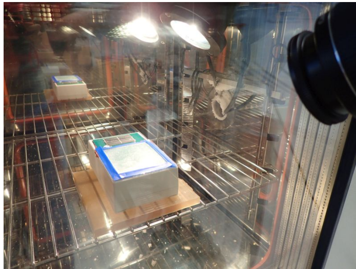
Abbildung 4.11: Versuchsaufbau. Gerät in Klimakammer, Elektrodenfläche bedeckt mit Eisfilm.
