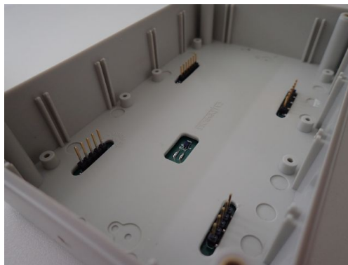
Abbildung 3.10: PT1000 (in der Mitte sichtbar) und die elektrischen Verbindungen – realisiert mit Stiftleisten – auf der Innenseite des Gehäuses (angebracht auf der Rückseite der Elektrodenplatine).
