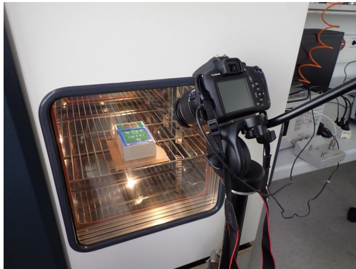
Abbildung 4.8: Versuchsaufbau. Gerät in Klimakammer bedeckt mit Wassertropfen.
