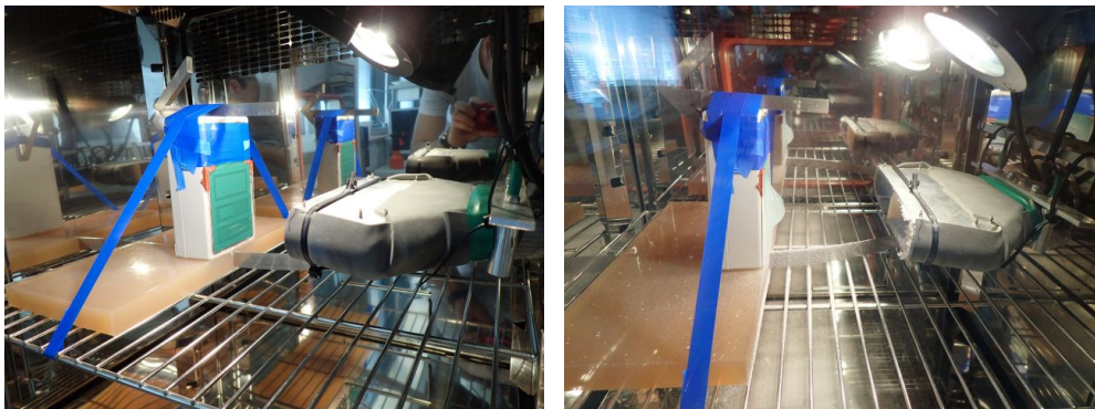
Abbildung 4.23: (links) Gerät stehend mit Sprühdüse in Klimakammer. (rechts) Eisbildung auf Elektrodenfläche.
