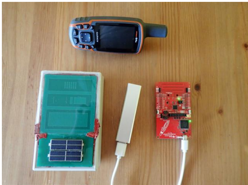
Abbildung 5.10: Darstellung der verwendeten Geräte. Oben ist das GPS, links unten der Sensor und rechts unten die Basisstation – betrieben mithilfe eines Akkus – zu sehen.
