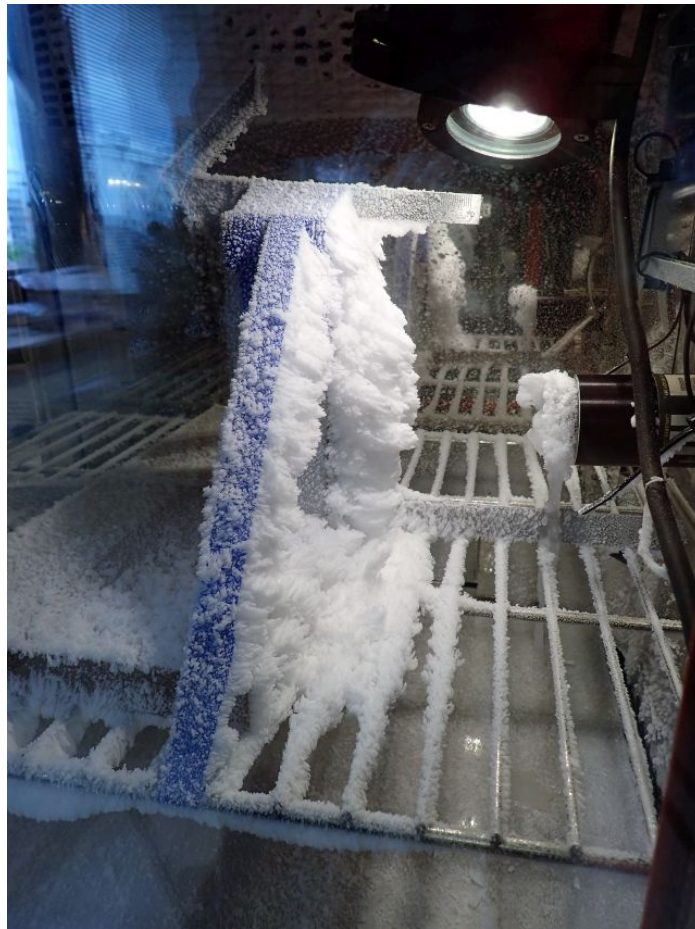
Abbildung 4.27: Versuchsaufbau. Gerät in Klimakammer, bedeckt mit Raureif. Der Luftbefeuchtereinlass ist rechts zu sehen.
