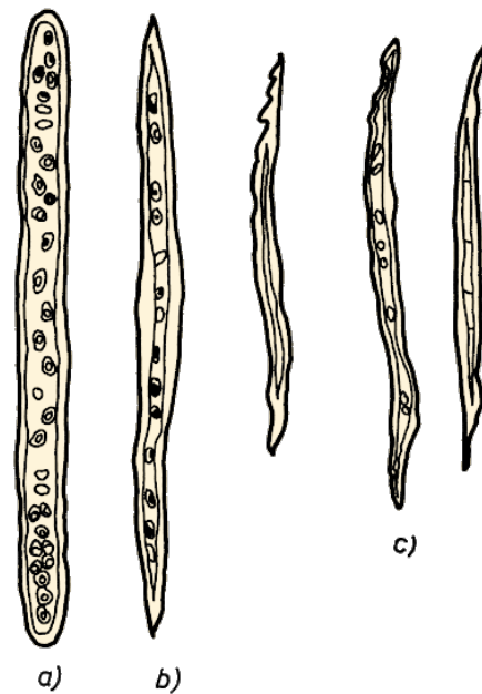
Abbildung 2.2 Faserformen a) Frühjahrstracheiden, b) Sommertracheiden, c) Libriformfasern adaptiert aus [2]
