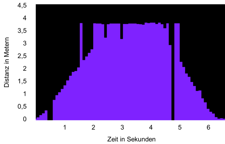
Abbildung 3.18.: Zu niedrige Verstärkung Ab einer gewissen Distanz wird nur noch die Wand erkannt.
