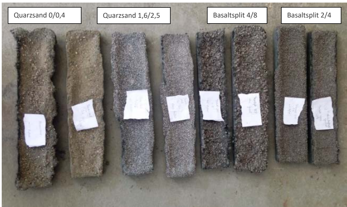
Abbildung 59: Acht Versuchskörper für die Oberflächenbeschaffenheit, oben jeweils ohne, unten mit Auflast
