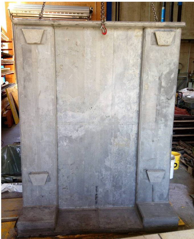
Abbildung 72: oben: Randbalkenoberfläche, links: Randbalken nach dem Ausschalen von unten, rechts: Seite und Oberseite des Randbalkenprototyps
