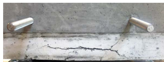
Abbildung 55: links: Versuchsergebnisse der ersten Serie, rechts; Rissbild im Versuchskörper nach Ende des Schubversuches, Vorder- und Rückseite
