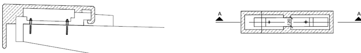
Abbildung 28: Passtück mit Klappmechanismus, Schnitt A-A (links) und Draufsicht (rechts)
