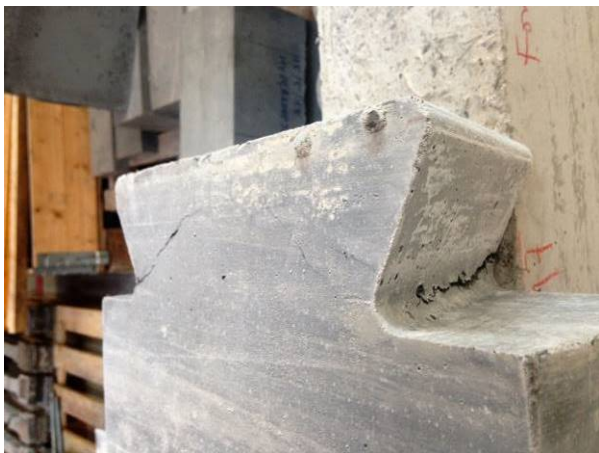
Versuchsaufbau und Rissbild Druckversuche, 2. Versuchsreihe:
