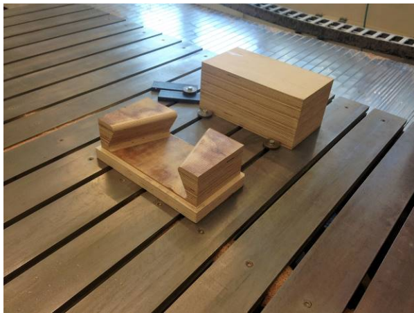
Beschichten der Schalungseinsätze und Schalung und Betonage der ersten Versuchsreihe:
