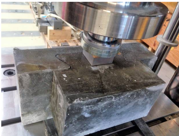
Versuchsaufbau und Rissbild Druckversuche, 2. Versuchsreihe:
