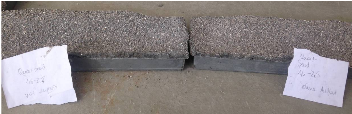
Abbildung 60: Gegenüberstellung Oberfläche mit Quarzsand 1,6/2,5 mit Auflast (links) und ohne Auflast (rechts)
