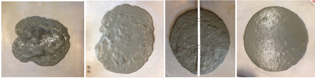
Abbildung 38: Setzfließmaß der diversen getesteten UHPC-Rezepturen - rechts : verwendete Betonsorte
