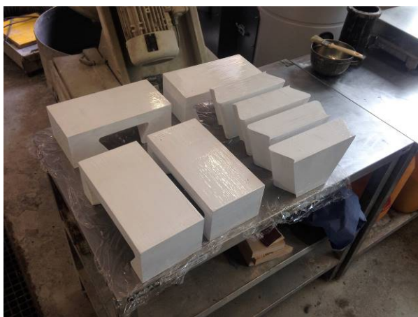
Beschichten der Schalungseinsätze und Schalung und Betonage der ersten Versuchsreihe:
