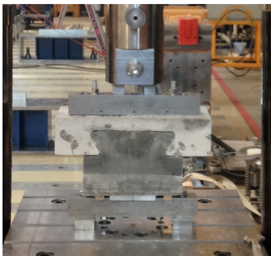
Abbildung 49: Versuchsaufbau Zugversuch 2. Versuchsreihe
