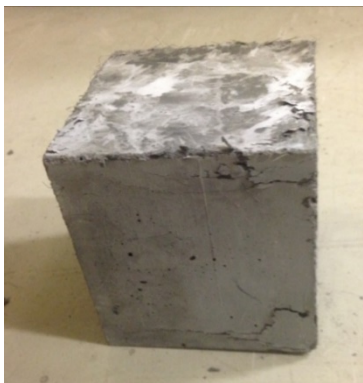
Abbildung 40: Probewürfel nach Ende des Druckversuches (links); Würfeldruckmessgerät (rechts)
