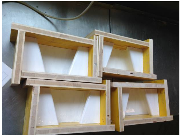
Beschichten der Schalungseinsätze und Schalung und Betonage der ersten Versuchsreihe:
