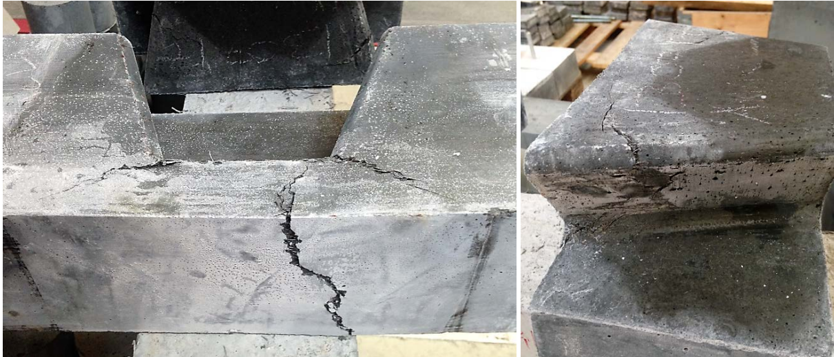
Abbildung 57: Biegerisse im Gegenstück (links) und leichte Risse im Schwalbenschwanz (rechts) – Versuchskörper 1
