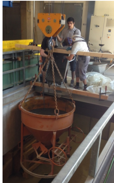
Abbildung 69: links: Ausbreitmaß der ersten Mischung des Zyklusmischer; rechts: Einfüllen des Betons in den Krankübel
