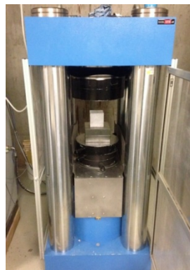
Abbildung 40: Probewürfel nach Ende des Druckversuches (links); Würfeldruckmessgerät (rechts)
