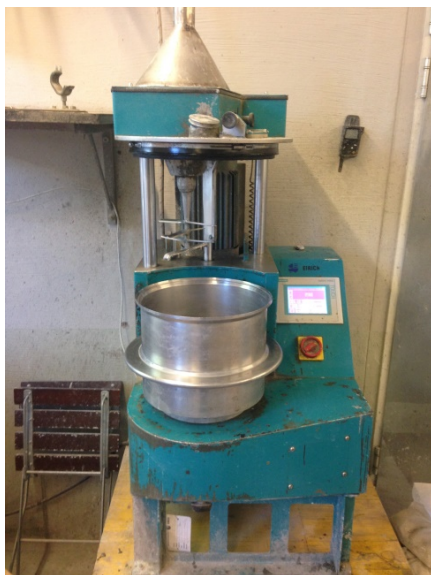
Abbildung 39: Eirich Intensivmischer im Betonlabor
