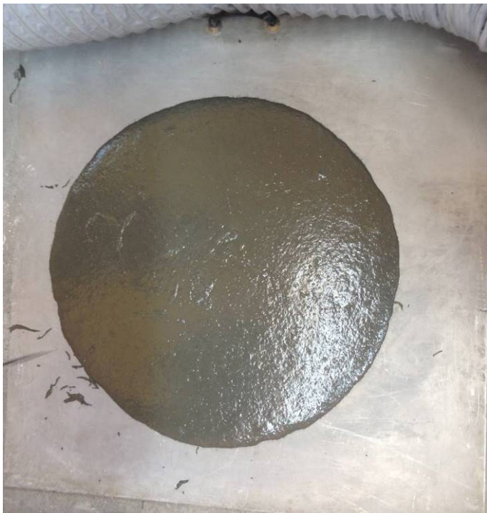
Abbildung 69: links: Ausbreitmaß der ersten Mischung des Zyklusmischer; rechts: Einfüllen des Betons in den Krankübel
