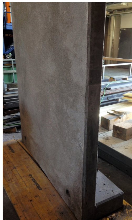
Abbildung 72: oben: Randbalkenoberfläche, links: Randbalken nach dem Ausschalen von unten, rechts: Seite und Oberseite des Randbalkenprototyps
