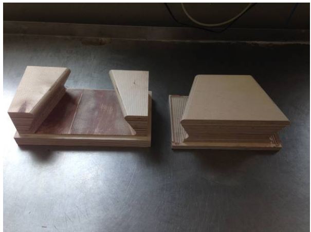
Beschichten der Schalungseinsätze und Schalung und Betonage der ersten Versuchsreihe:
