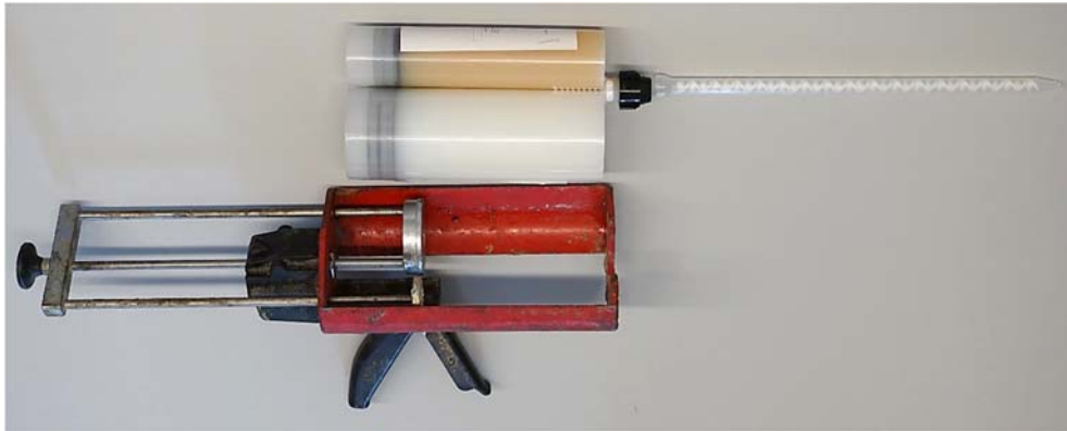
Abbildung 5-6: Handpistole mit WEVO Spezialharz EP 32 S [95] 2K-Kartusche und Statikmixer
