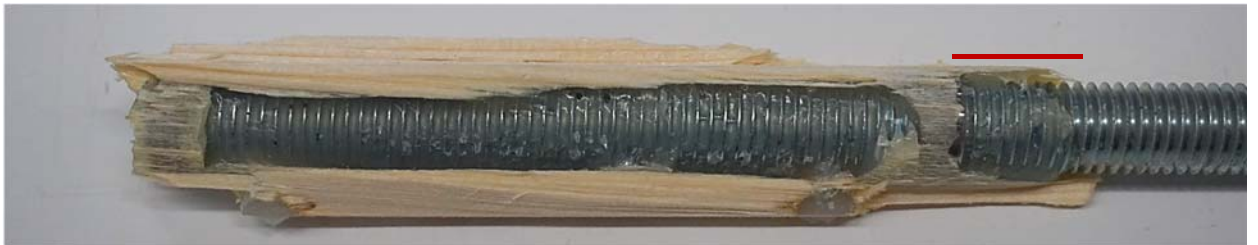
Abbildung 5-19: Beispiel einer zu langen Verklebung
