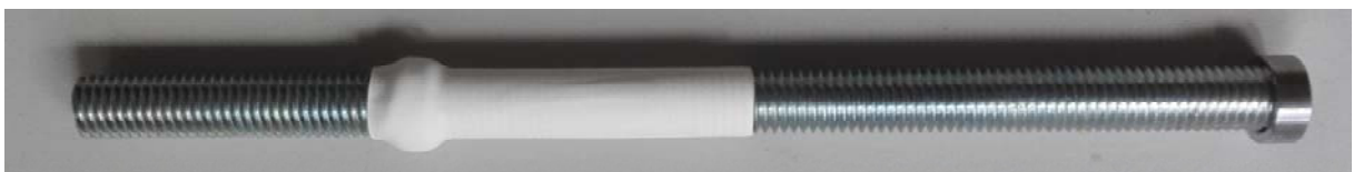
Abbildung 6-12: Gewindestange der Vorversuche V5 mit Zentrierhülse und Schrumpfschlauch im Bereich l_{emb}
