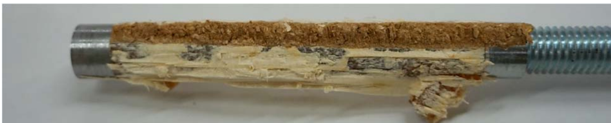
Abbildung 5-17: Beispiel einer Probe mit Mark entlang der Verklebung
