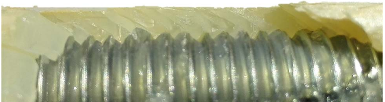
Abbildung 7-1 ersichtlich, Risse in einem Winkel zwischen 30° und 33° zur Stabachse. Dies entspricht dem halben Flankenwinkel des Gewindes (30°).
