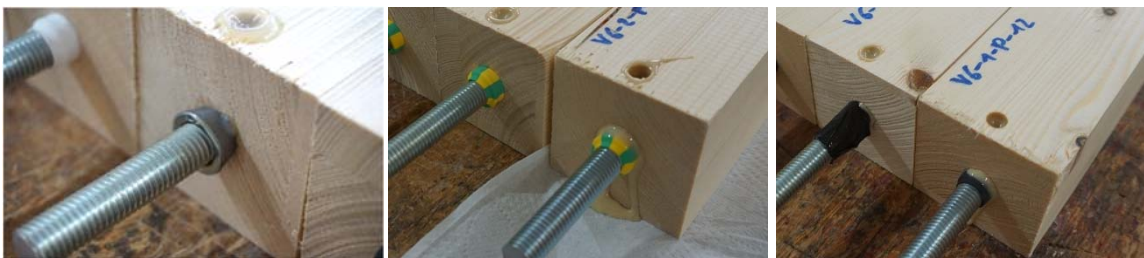
Abbildung 6-14: Auslaufen des Klebstoffes neben der externen Zentrierung links: Kegelstumpf
