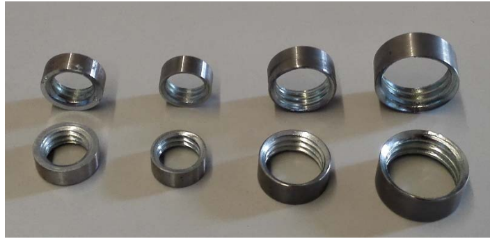
Abbildung 5-1: Abgedrehte Muttern als Abstandshülsen mit unterschiedlichen Durchmessern
