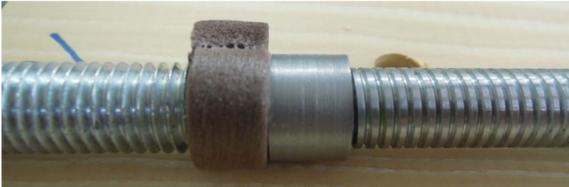
Abbildung 6-5: Gewindestange mit Abstandshülse und teilweise abgedrehtem Gewinde
