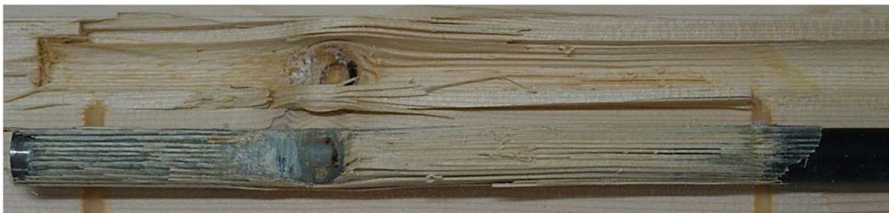
Abbildung 5-16: Beispiel eines Astes in der Verklebung
