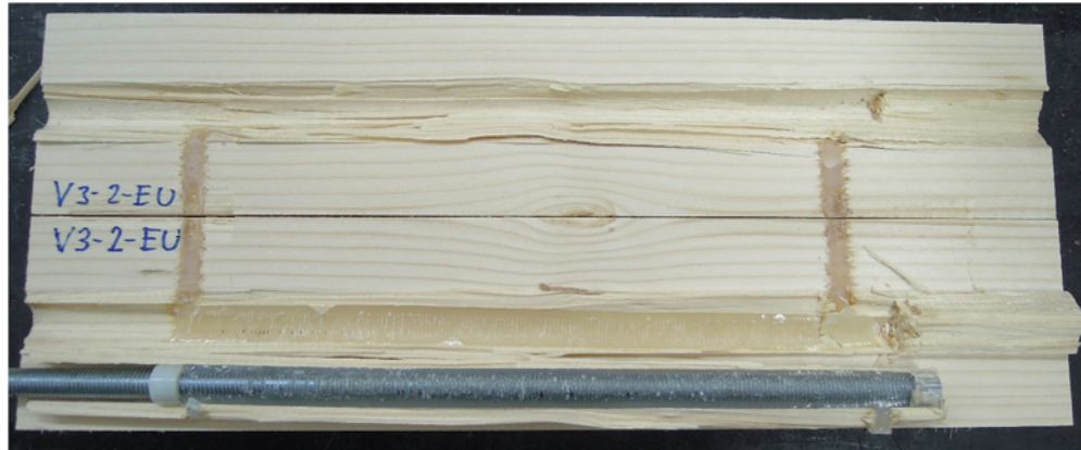
Abbildung 5-14: Beispiel einer aufgespaltenen Probe aus Vorversuch 3
