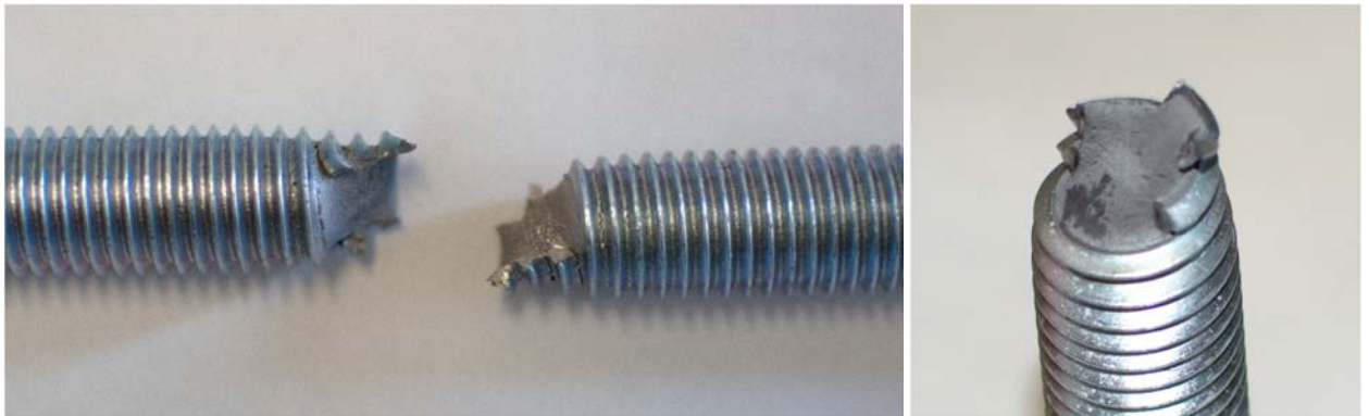
Abbildung 7-8: Bruchflächen der getesteten Gewindestangen des Typs M12
