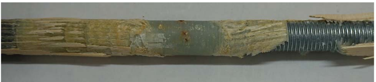
Abbildung 5-24: Beispiel eines teilweisen Adhäsionsversagens
