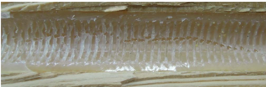
Abbildung 6-6: Luftblasen bei abgedrehter Gewindestange V2
