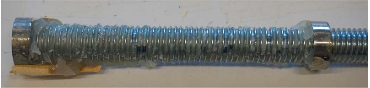
Abbildung 5-22: Beispiel eines möglichen Kohäsionsversagens des Klebstoffes (Das Bild zeigt keine Bruchfläche sondern wurde an einer nicht gebrochenen Verklebung die mechanisch gespalten wurde erstellt.)
