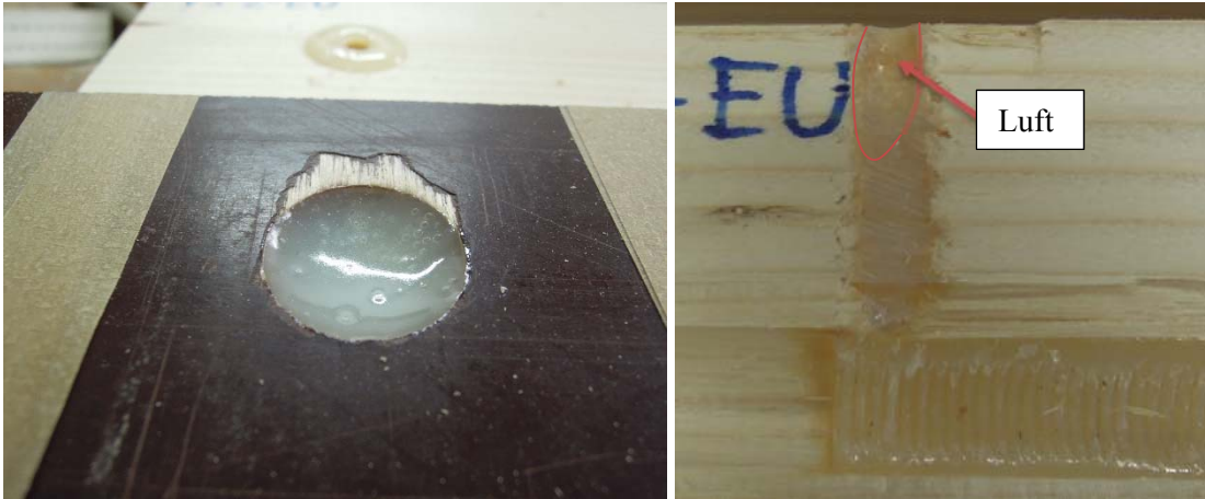
Abbildung 6-9: Absenkung des Klebstoffes der austretende Luftblasen links: V3-2-ED+ rechts: V3-2-ED
