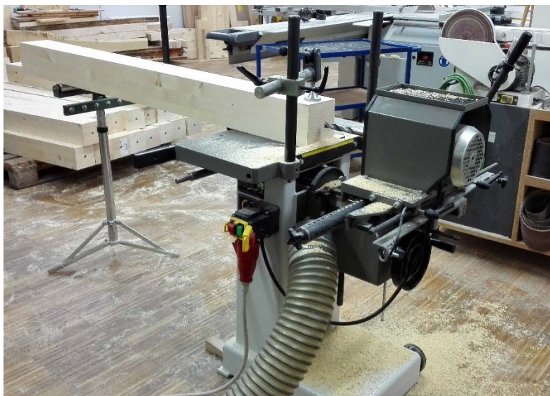
Abbildung 5-5: Langlochbohrmaschine zur Herstellung einer zentrischen Bohrung
