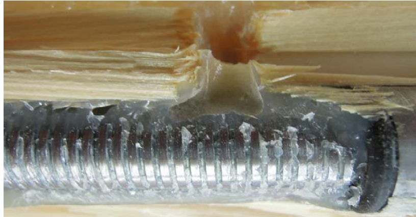
Abbildung 6-7: Fotodokumentation einer noch oben hin entweichenden Luftblase
