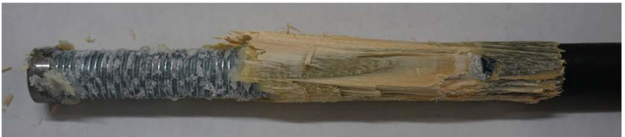
Abbildung 5-23: Beispiel eines Mischbruches aus Schubbruch im Holz und Kohäsionsversagen des Klebstoffes
