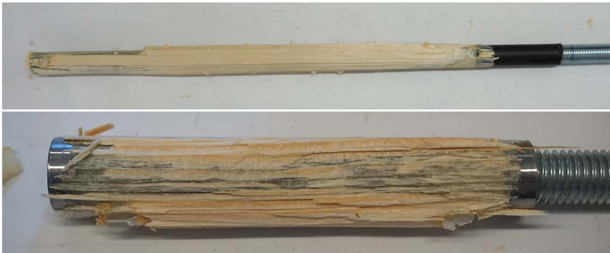
Abbildung 5-21: Beispiel zweier durch Holzschubbruch versagter eingeklebter Gewindestangen
