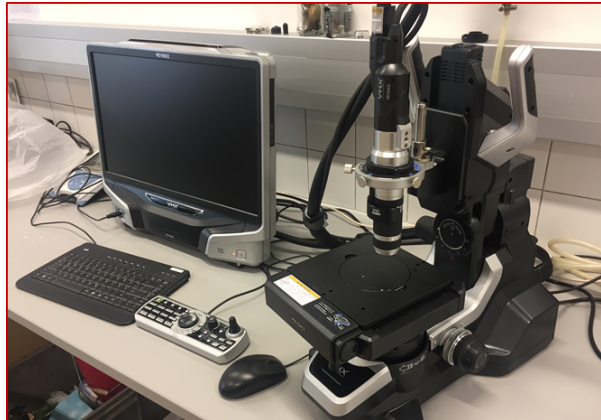
Abbildung 5.1.: Dig. Lichtmikroskop vom Typus Keyence VHX-5000 - IMBT, TU Graz
