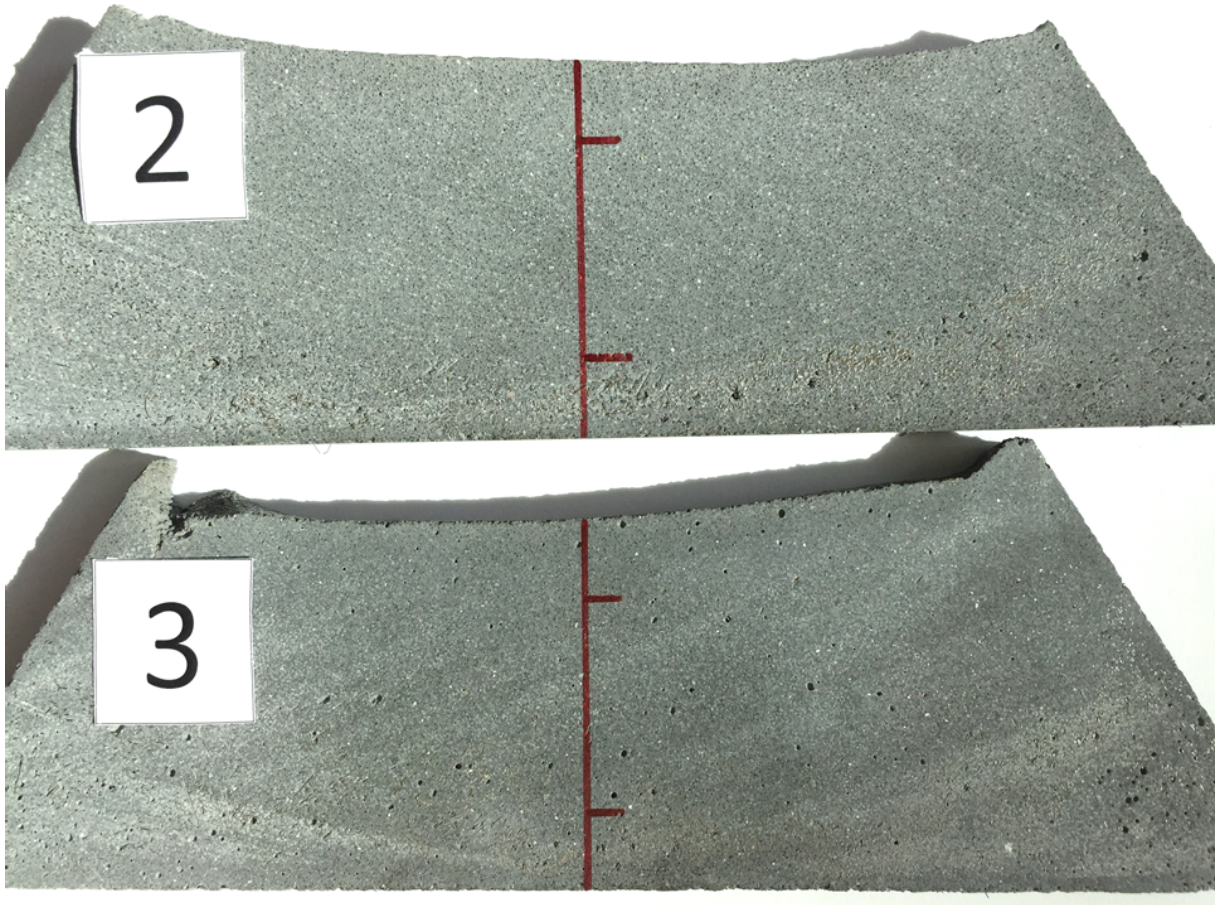
Abbildung 5.24.: Vergleich von Probe 2 zu Probe 3 hinsichtlich der Verdichtungs-poren
