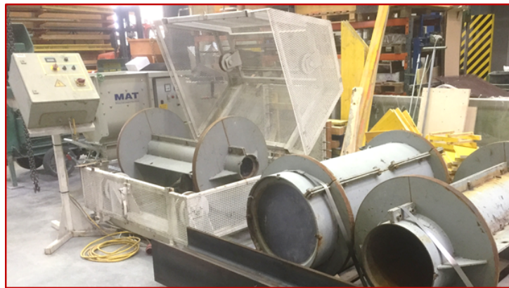
Abbildung 5.2.: Betonschleuder mit Schalungsrohren - Fa. Maba
