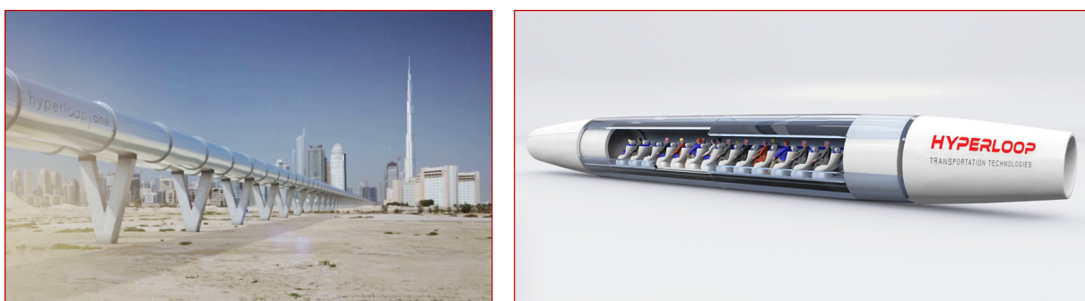
Abbildung 1.1.: Hyperlooptrasse mit zwei Röhren auf Stützen (links), Transportkapsel (rechts) [Hyperloop.2017]
