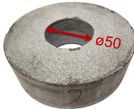
Abbildung 6.8.: Probekörper \varnothing 50 mm für die Instationäre Messung von Probe 2
