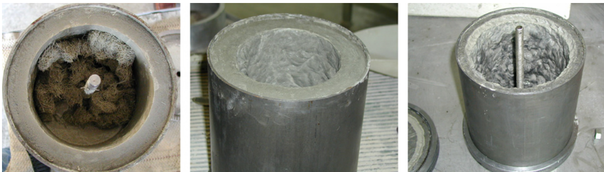
Abbildung 4.17.: Faserentmischung - PVA-Fasern (links und Mitte), Carbonfasern (rechts) [Kaufmann.2007]
