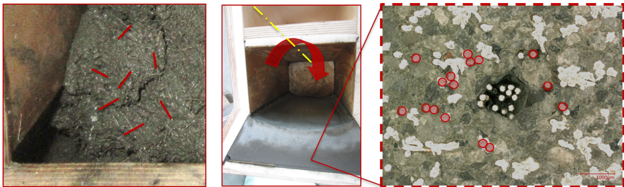
Abbildung 5.20.: Faseranordnung in Probe 2
