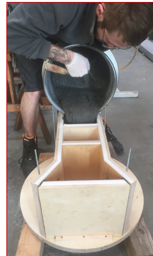
Abbildung 5.5.: Betonieren des Gegengewichtes
