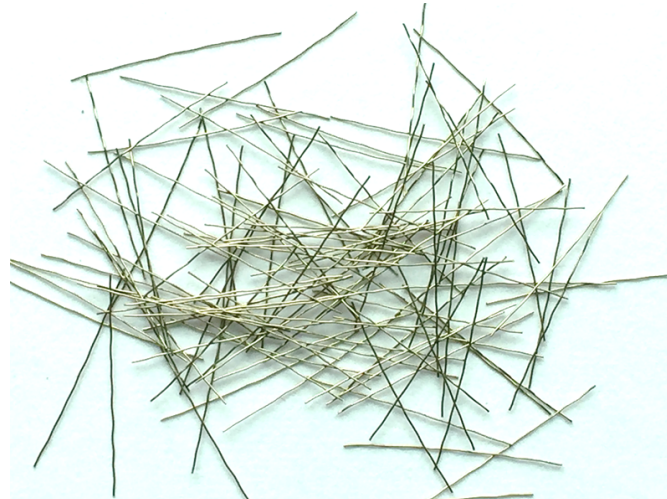
Abbildung 5.25.: Strukturierte Stahlfasern - Schlankheit \lambda \sim 100
