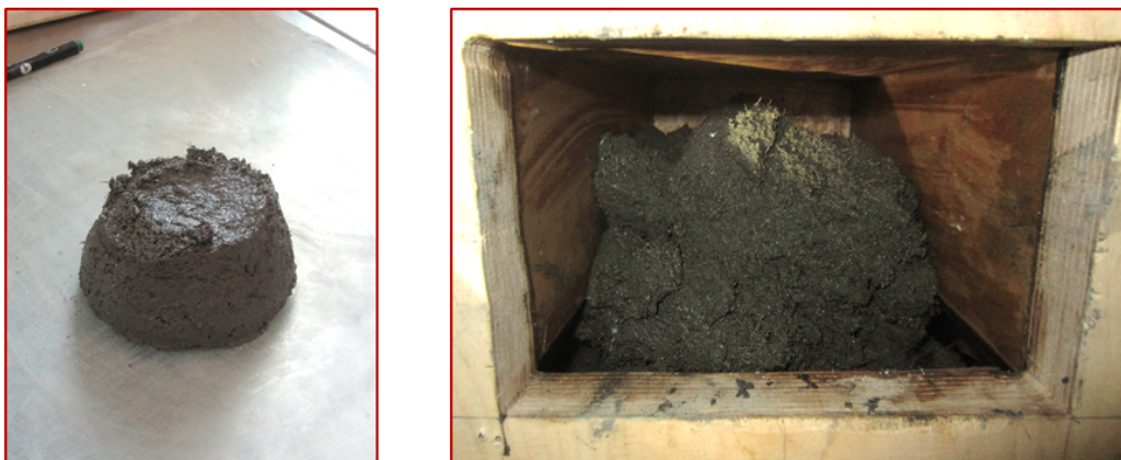
Abbildung 5.16.: Konsistenzprüfung mittels Hägermann-Konus (links), Probe vor Beginn des Schleudervorgangs (rechts) - Probe 2
