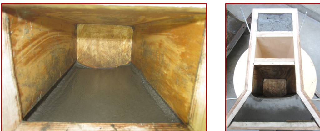
Abbildung 5.17.: Probe 2 nach Schleuderende (links), Probe 2 beim Ausschalen (rechts)
