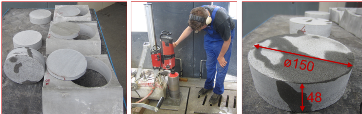
Abbildung 6.4.: Bohren der Probekörper aus den geschleuderten UHPC-Proben
