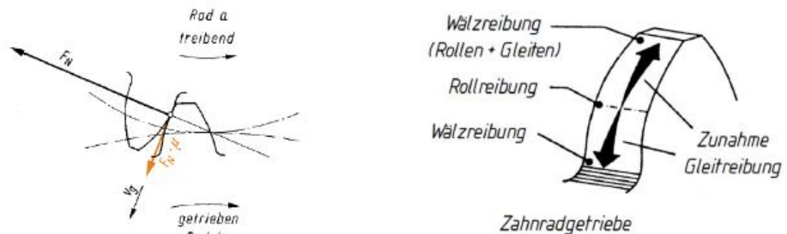
Bild 3.14: Kräfte und Reibungsbereiche einer Verzahnung [4]
