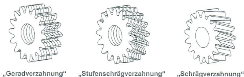
Bild 2.8: Entstehung der Schrägverzahnung [5]
