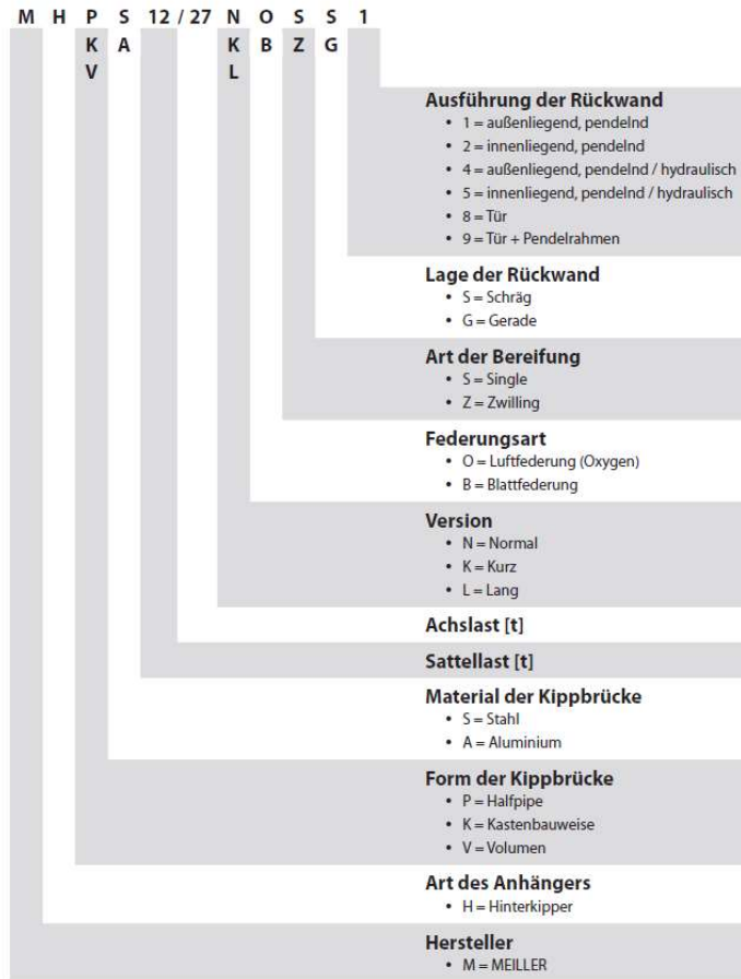
Bild 5-5 Erklärung für Baumusterbezeichnung von Meiller Kippsattelanhängern, Quelle: www.meiller.com
