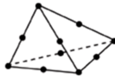
Modifiziertes Element 2. Ordnung (10-Node Tetraeder, C3D10M)
