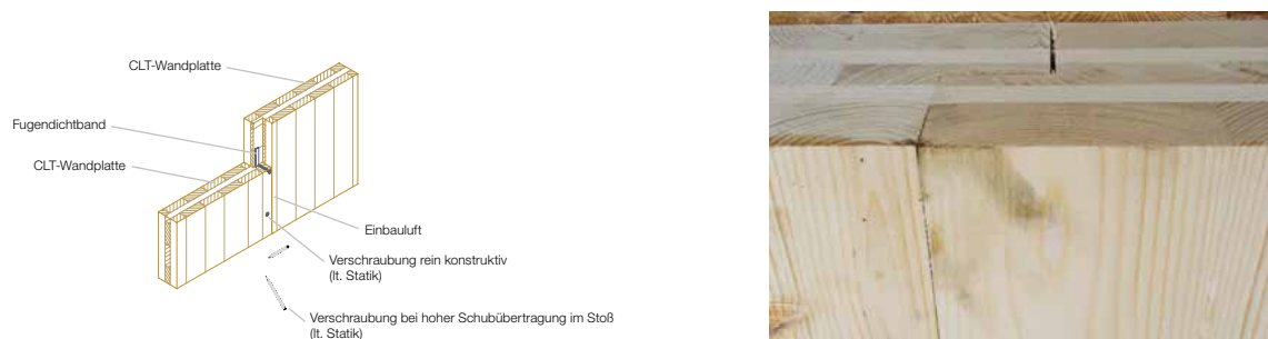
Abbildung 8.15: Wandstöße vertikal mit Stufenfalz (CLT- Stora Enso)
