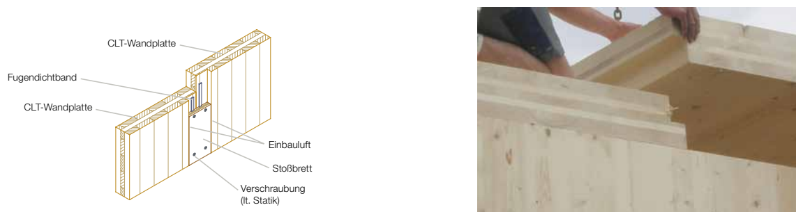
Abbildung 8.16: Wandstöße vertikal mit Stoßbrett (CLT-Stora Enso)
