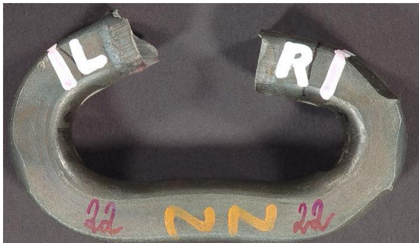
Abbildung 3: Versagen in der Schweißzone eines widerstandstumpfgeschweißten Kettengliedes
