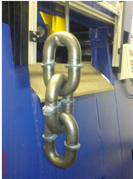
Abbildung 31: Erste Rundstahlkette hergestellt durch den RSM1
