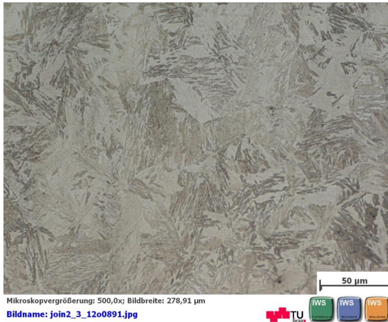
Abbildung 36: Grundwerkstoff 30CrNiMo8 der Kettenglieder
