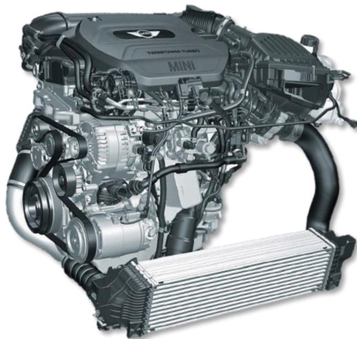
Abbildung 4.1: Versuchsträger BMW B47C2000 aus einem Mini Cooper SD F56 [1]
