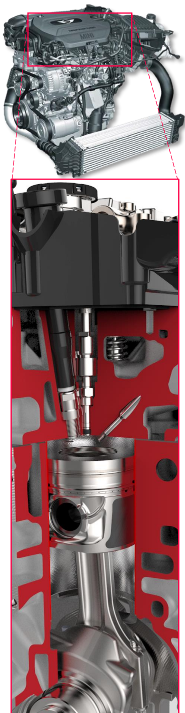
Abbildung 4.10: Übersicht mono-valentes Erdgaskonzept mit innerer Gemischbildung (Direkteinblasung DI)
