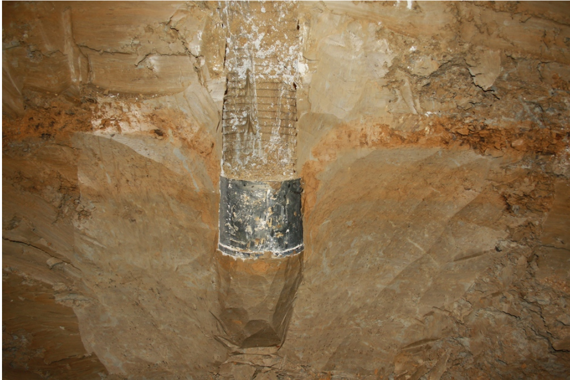
Abbildung 3.52: Die freigelegte Pfahlspitze des Pfahles P1B der Versuchsreihe 1 – Bodenaustausch
