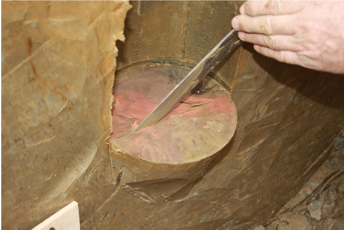
Abbildung 3.41: Großaufnahme des Pfahlaufstandsfläche P3A und das Abtrennen des Probenstückes für weitere Untersuchungen
