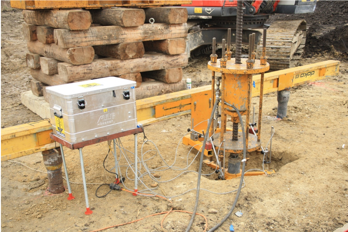
Abbildung 3.22: Das aufgebaute Pile HAY-Proof-System ® und die montierte Messausrüstung
