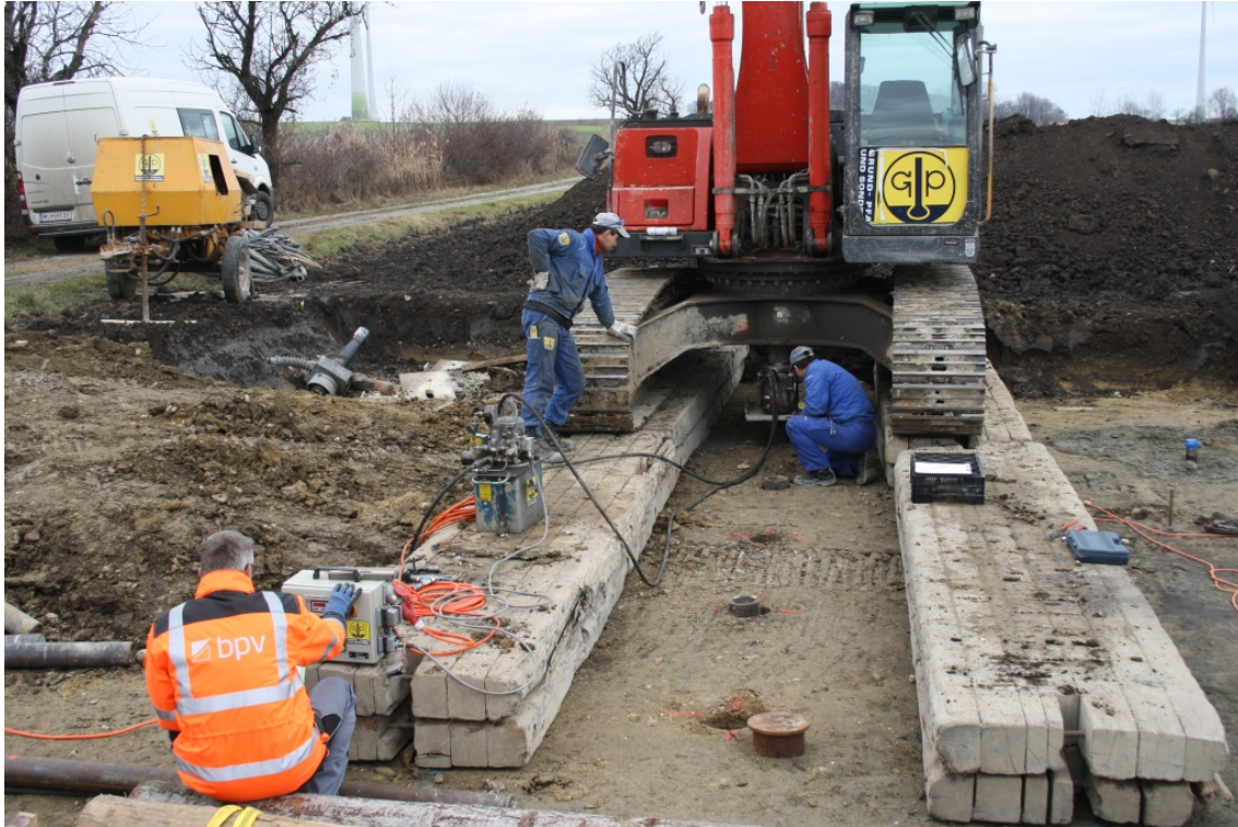
Abbildung 3.19: Übersicht Probelastung mit Todlast
