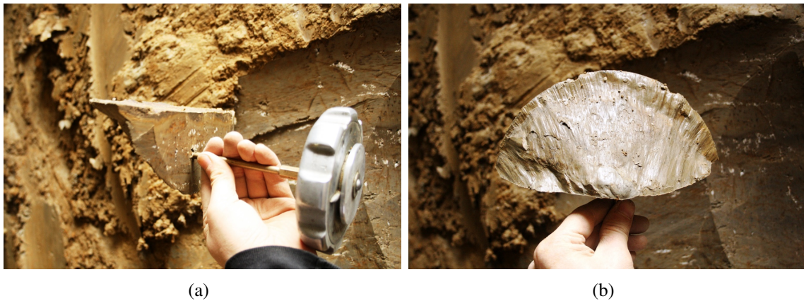
Abbildung 3.67: Das Probenstück A bei der Entnahme aus dem freigelegten Pfahlprofil PP02.
