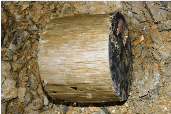
Abbildung 3.64: Entnommene Fußkappe des Pfahles PP02.
