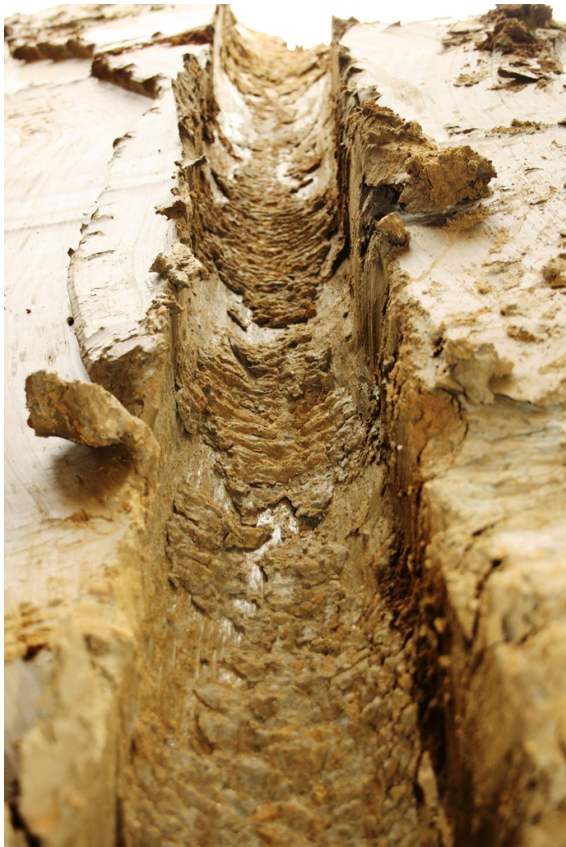
Abbildung 3.59: Pfahlschaftbereich nach der Entnahme des Probepfahles PP02
