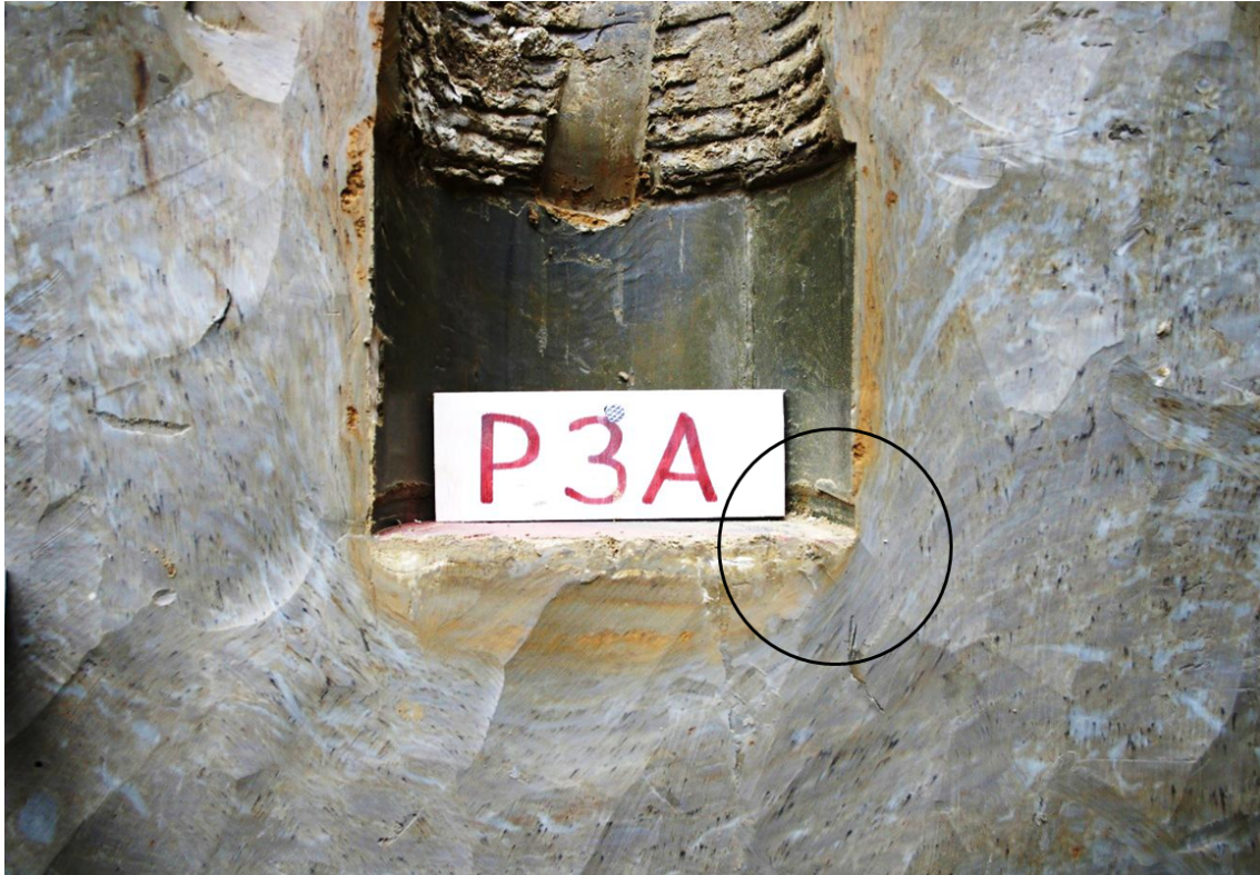
Abbildung 3.44: Profilschnitt des Pfahlspitzebereiches P3A (Großaufnahmen)
