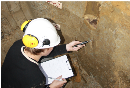
Abbildung 3.78: Messung mit dem Taschenpenetrometer.
