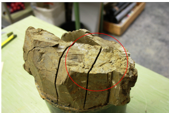
Abbildung 3.75: Sichtbare Scherflächen am Probenstück B.
