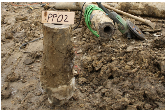
Abbildung 3.59: Pfahlschaftbereich nach der Entnahme des Probepfahles PP02
