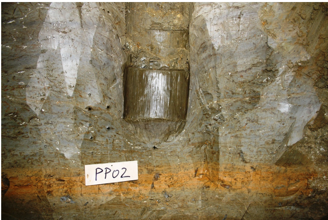
Abbildung 3.69: Das freigelegten Pfahlprofil PP02, nach Entnahmen des Probenstückes A (Seitenansicht).
