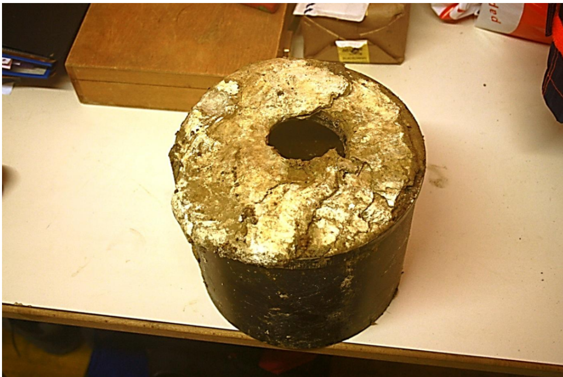
Abbildung 3.49: Entnommenen Fußkappe des Pfahles P2B – „weiße Scherflächen“
