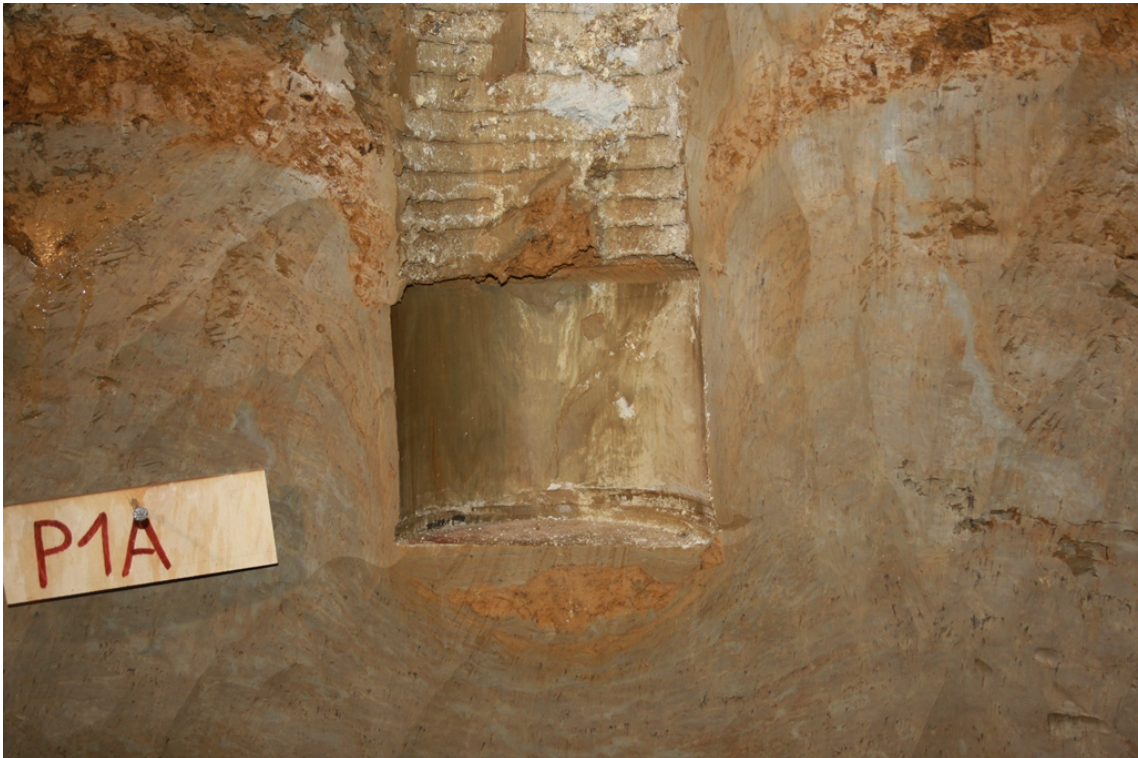
Abbildung 3.53: Großaufnahme der freigelegte Pfahlspitze des Pfahles P1A
