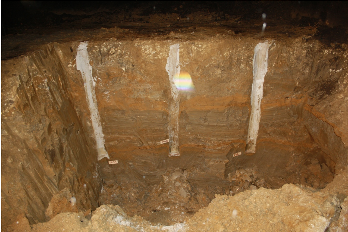
Abbildung 3.55: Die freigelegte Pfähle der Versuchsreihe 1 – Bodenaustausch
