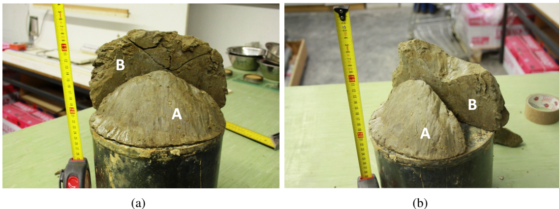
Abbildung 3.70: Die Probenstücke A und B vor der Untersuchung auf einer umgedrehten Fußkappe platziert.
