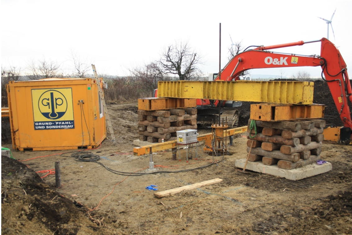
Abbildung 3.21: Übersicht über den Versuchsaufbau des Pile HAY-Proof-Systems® und des Sekundärzugversuches am Versuchsfeld Hollern
