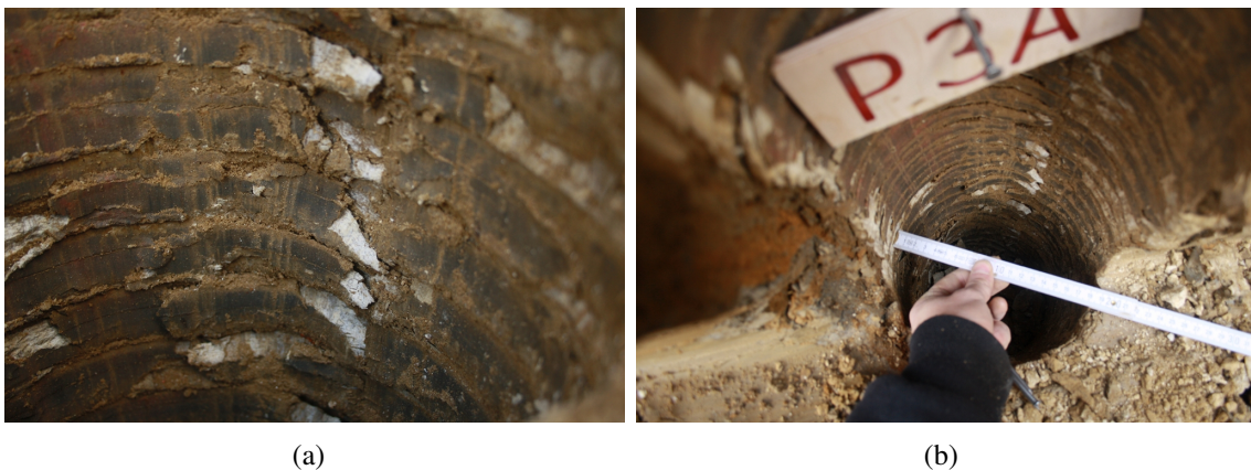
Abbildung 3.28: Pfahllaibung und Pfahlschaftdruchmesser
