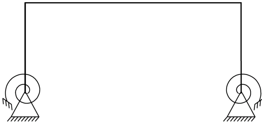
ABBILDUNG 16: BIEGESTEIFES (RAHMEN-) SYSTEM
