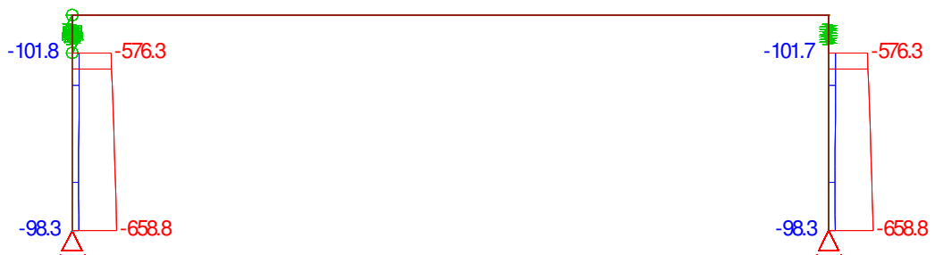
ABBILDUNG A 9: NORMALKRAFTVERLAUF – SYSTEM 2, EUROCODE, GELENKIG
