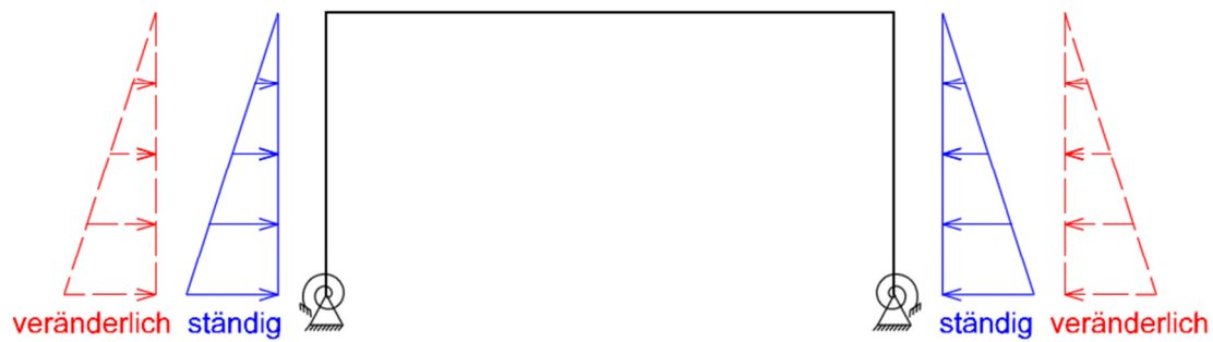
ABBILDUNG 22: EINWIRKUNGEN INFOLGE ERDDRUCK OHNE VERKEHR
