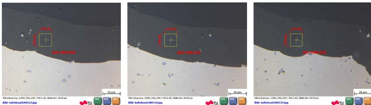
Abbildung 110: Probe N3; Härte und Schichtdicke im Querschliff (xx / yy / 21 µm - 333/343/351 HV0,01)
