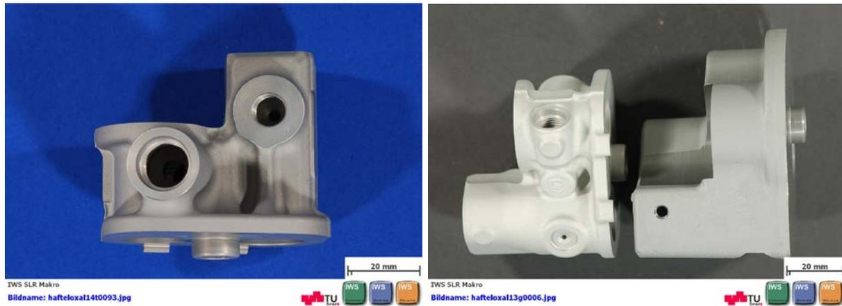
**Abbildung 60: Airbag-Komponente (Volkswagen) / EN AC 5083 Guss / Schichtdicken 10-25µm (Proben: N1-N6 und H1-H5)**
