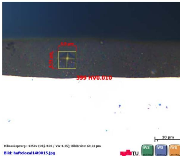
**Abbildung 70: Probe 1; Mikrohärte Messung**
