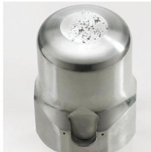
**Abbildung 52: Fehler (Galvanische Korrosion), [38].**
