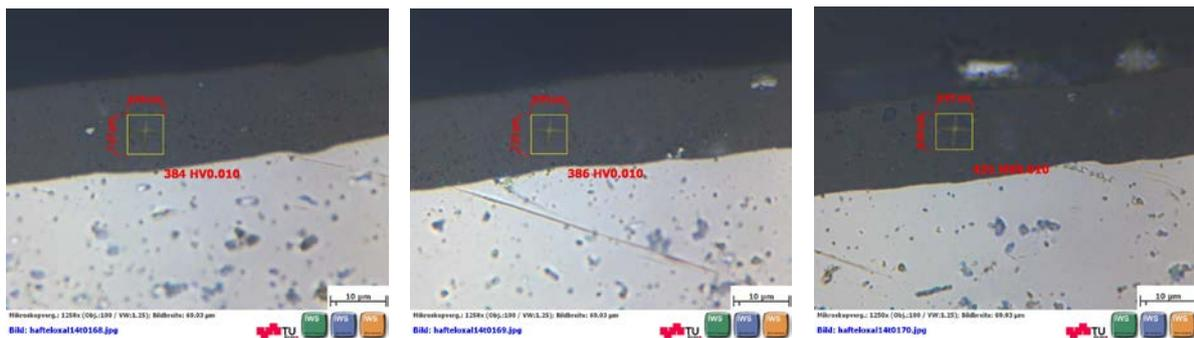
Abbildung 107: Probe H5; Härte und Schichtdicke im Querschliff (xx / yy / 21 µm - 384/386/421 HV0,01)
