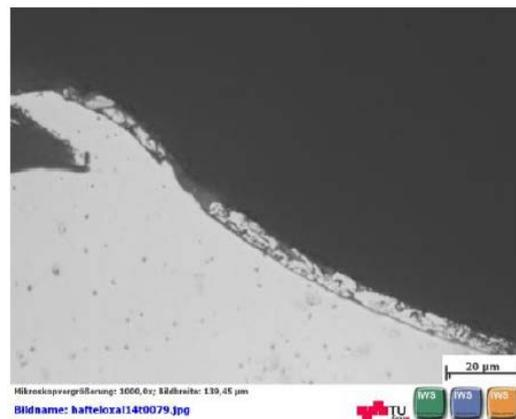
**Abbildung 67: Metallographische Querschliffe nach Verschleißtest ‚Harteloxal‘ (li.) Probe H2 Verschleißspur - Abtrag des Grundwerkstoffes; (re.) Probe H4 am Rand der Verschleißspur / Verschleißweg u. -geschwindigkeit je 14m / 3,5cm/s, Prüfdruck 38MPa**
