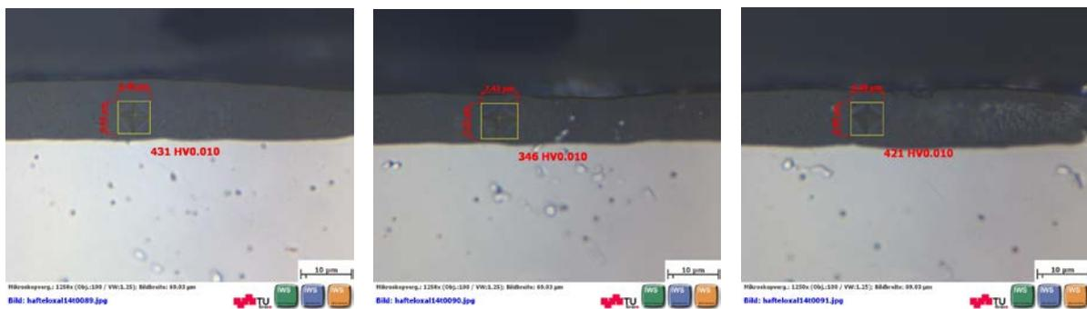
Abbildung 106: Probe H4; Härte und Schichtdicke im Querschliff (xx / yy / 21 µm - 431/346/421 HV0,01)
