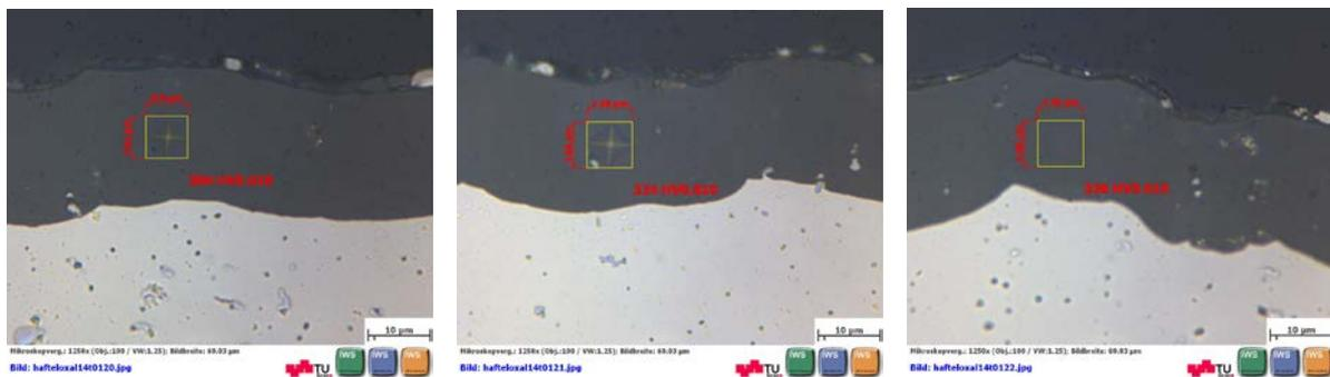
Abbildung 112: Probe N5; Härte und Schichtdicke im Querschliff (xx / yy / 21 µm - 384/324/392 HV0,01)
