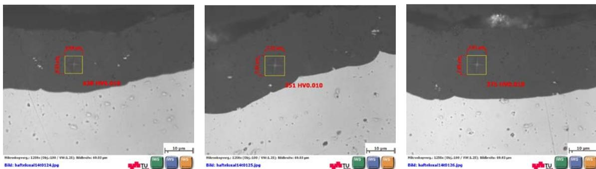
Abbildung 113: Probe N6; Härte und Schichtdicke im Querschliff (xx / yy / 21 µm - 438/351/375 HV0,01)
