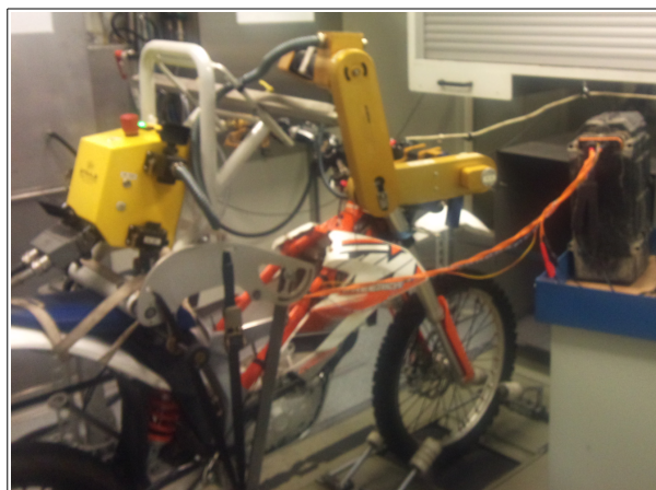
Abbildung 39: Fahrroboter auf einem Prüfstand. Die Traktionsbatterie ist über ein Kabel angeschlossen um Messungen mit dem Oszilloskop zu ermöglichen.
