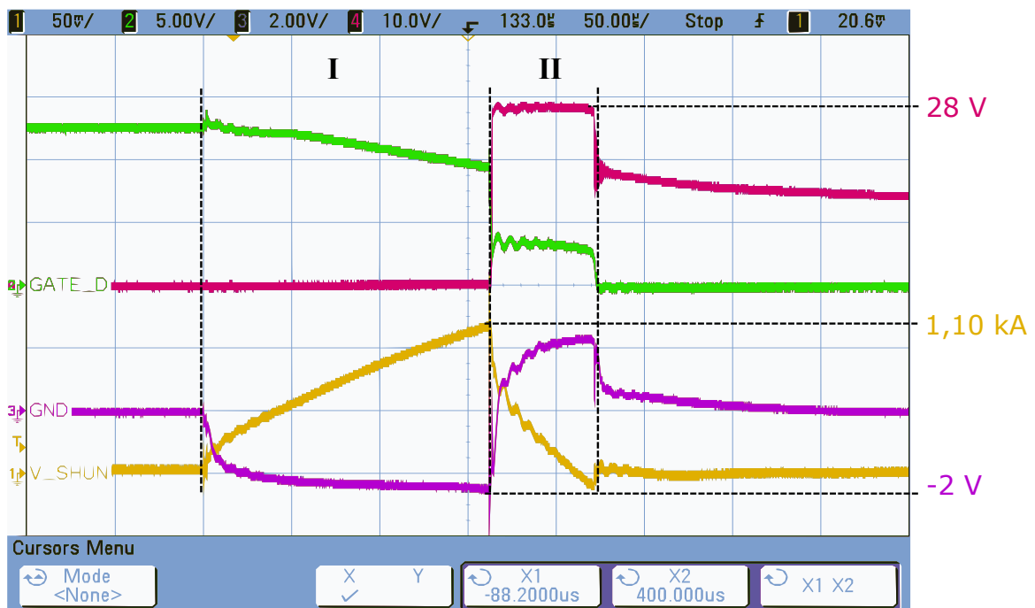
Abbildung 3.2: Abschaltung nach einem Kurzschlussstrom von ca. 1100 A
