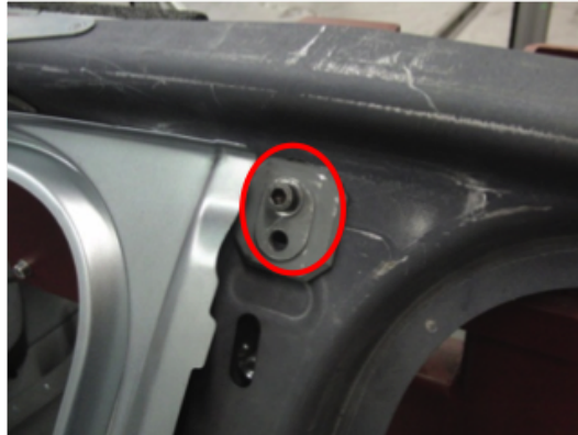
Abbildung 6.25: Schraube im oberen Bereich der B-Säule
