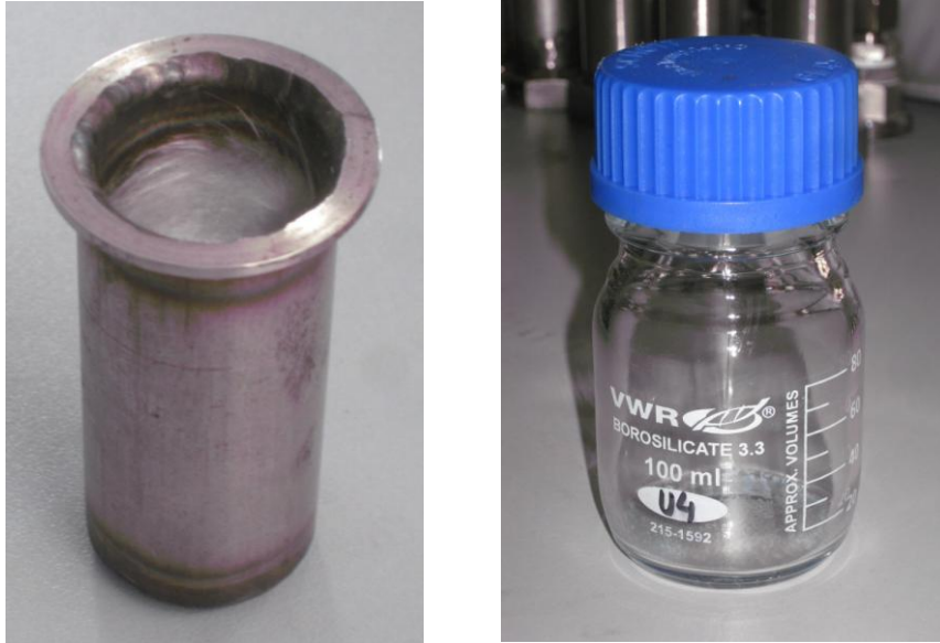
Abbildung 46: Filterhülse mit Filtergewebe (links), Laborflasche (rechts)
