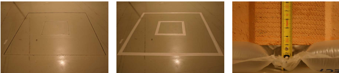
Abbildung 4.4: Experimentelle Modalanalyse: Untergrund und Lagerung des Prüfkörpers
