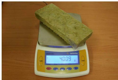
Abbildung 4.2: Rohdichte Mineralwolle: Bestimmung der Masse des Prüfkörpers
