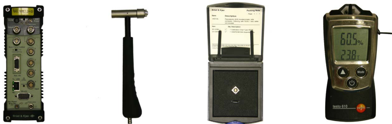
Abbildung 4.3: Experimentelle Modalanalyse - verwendete Messgeräte: Messsystem, Impulshammer, Beschleunigungssensor und Messgerät für Lufttemperatur und -feuchtigkeit (von links nach rechts)
