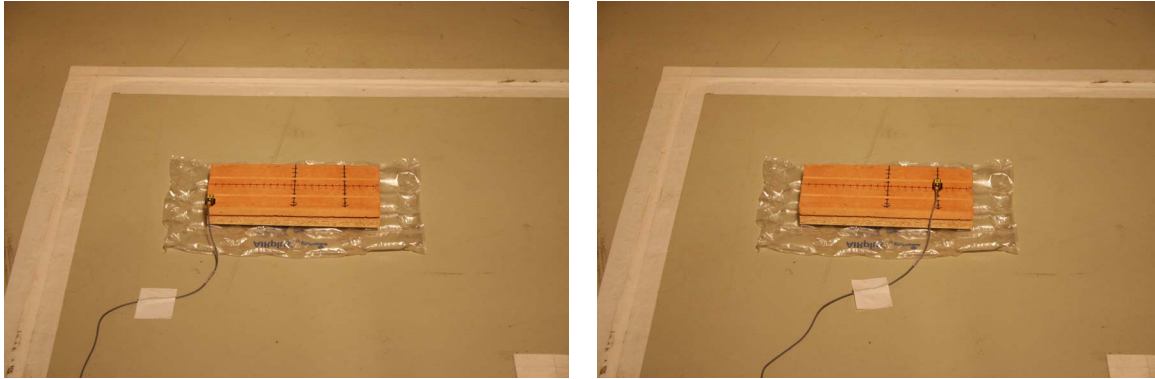
Abbildung 4.18: Aufnehmerposition im Wellenbauch (links) und im Wellenknoten (rechts)
