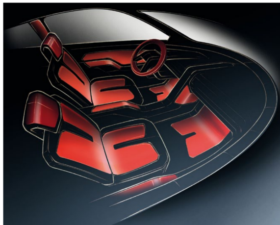
Abbildung 3.3: Beispiel für eine Flächenbeheizung im Fahrzeug (Wehner und Ackermann, 2011)
