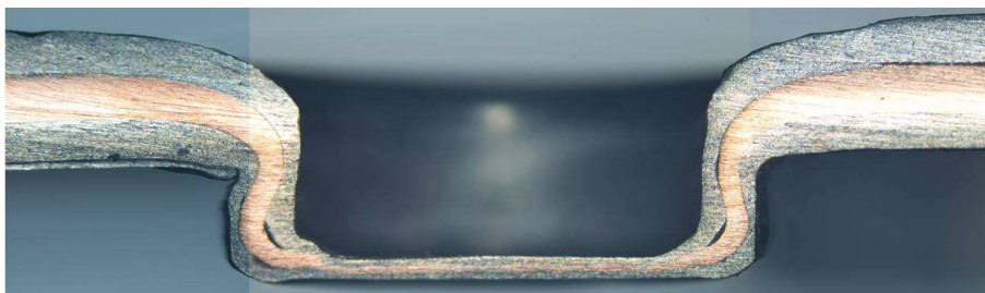
Abbildung 35: Querschliff eines Clinchpunktes der Referenzprobe Al-Cu-Al
