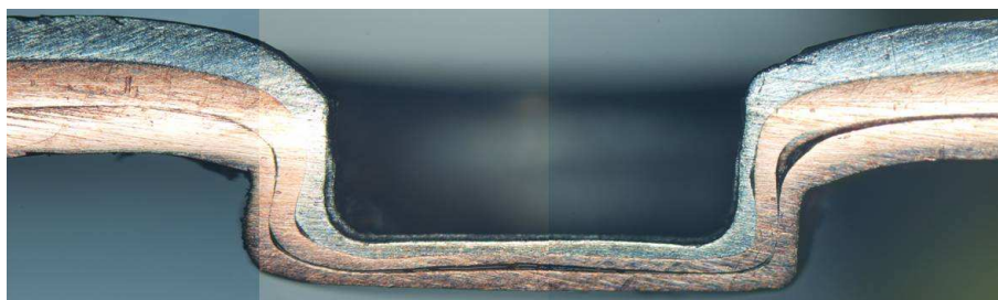
Abbildung 28: Querschliff eines Clinchpunktes der Referenzprobe Al-Cu-Cu
