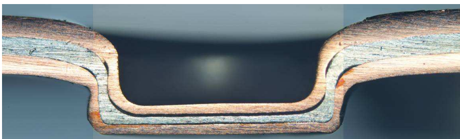
Abbildung 30: Querschliff eines Clinchpunktes der Referenzprobe Cu-Al-Cu
