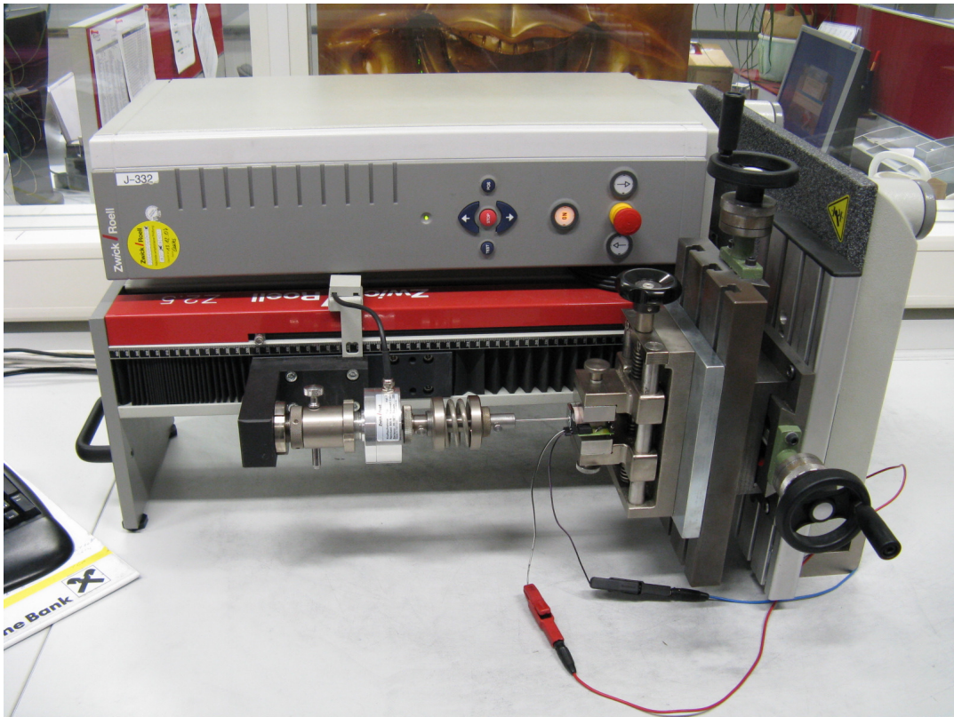
Abbildung A.2: Messaufbau Drehteilmagnet horizontale Aufspannung
