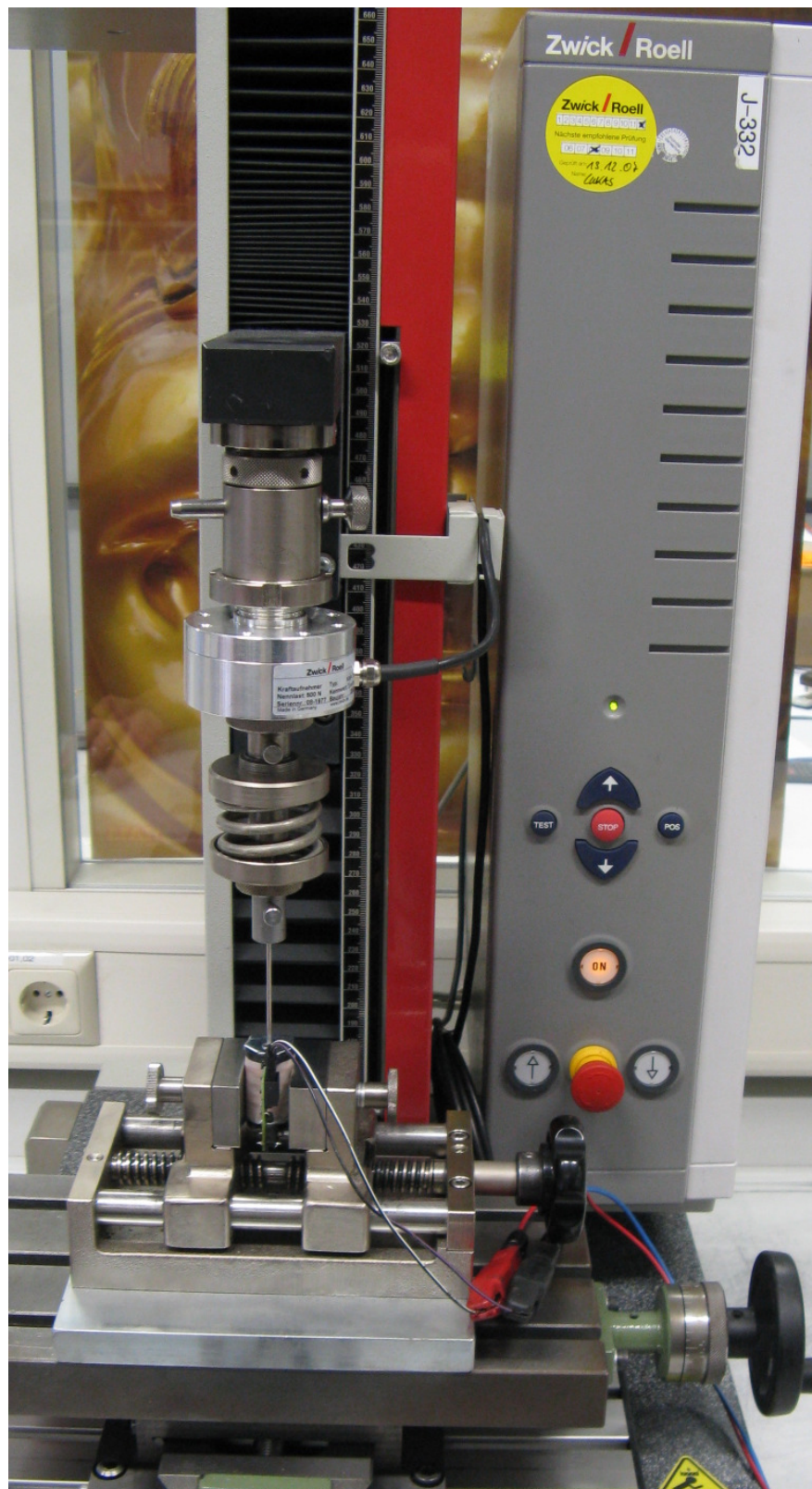
Abbildung A.1: Messaufbau Drehteilmagnet vertikale Aufspannung
