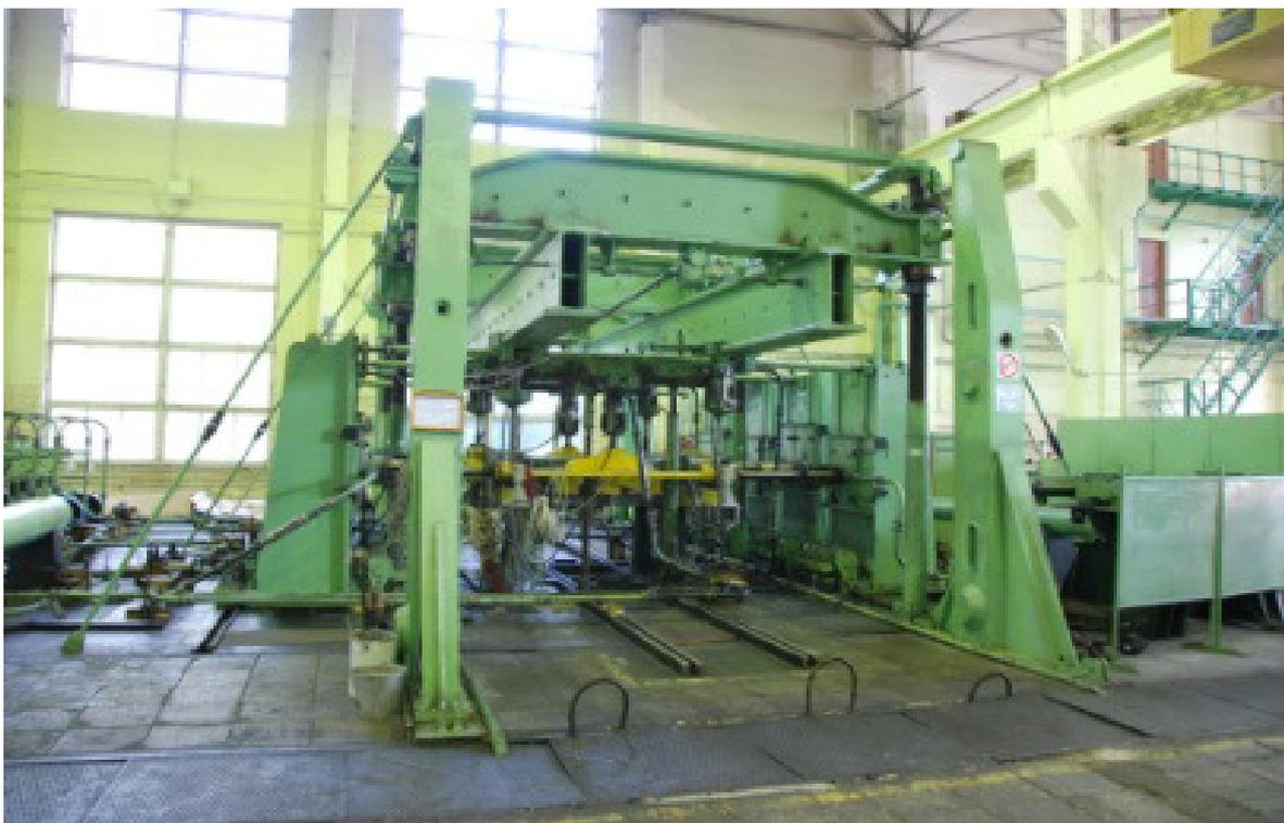
Abbildung 12 Prüfstand - Drehgestellrahmenprüfung (Quelle: VNIIZhT)
