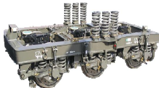
Abbildung 18 Einachsiges Fahrwerk (Quelle: Wikipedia) / Dreiaxsiges Fahrwerk
