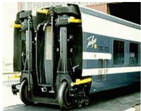
Abbildung 19 Losradlaufwerk Fahrwerk (Quelle: TALGO)
