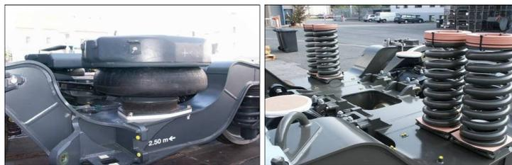
Abbildung 59 Sekundärfederung (Luftfederung, Schraubendruckfederung)
