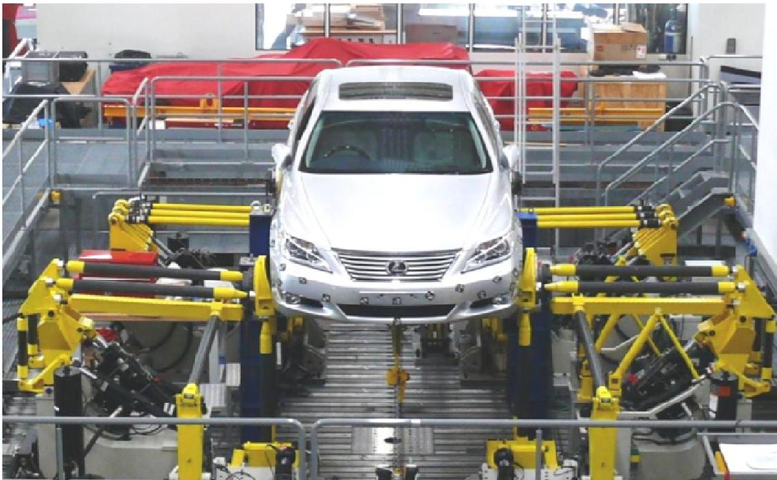
Abbildung 14 Straßensimulator ( MTS 329) der Toyota Motorsport GmbH<sup>17</sup>
