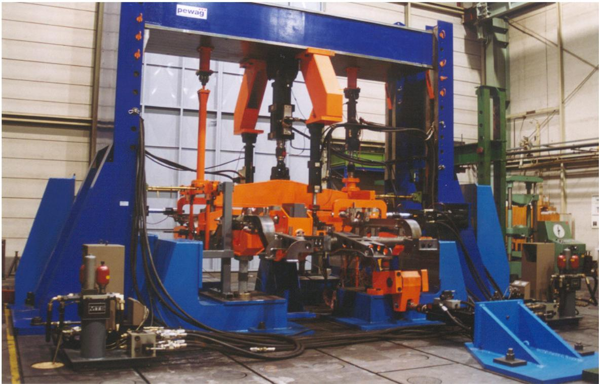
Abbildung 11 Portalprüfstand - Drehgestellrahmenprüfung (Quelle: SZA)
