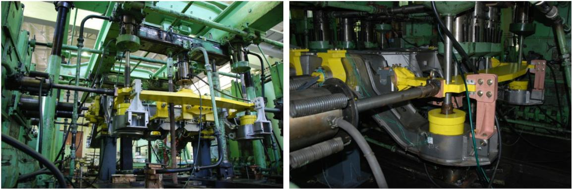
Abbildung 27a,b Prüfstand zur Drehgestellrahmenprüfung (Quelle: VNIIZhT / Wolfand)
