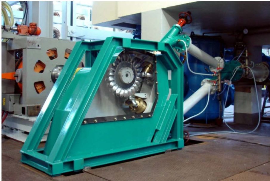
Abbildung 4-26: 2-düsiger Modellversuchsaufbau für Pelton-Turbinen [78]; S. 4
