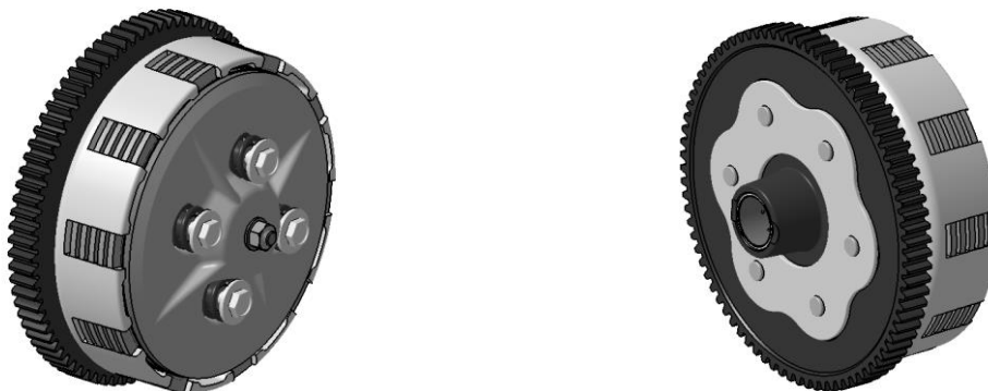
Abbildung 4-16: Mehrscheiben-Lamellenkupplung des Prototypen
