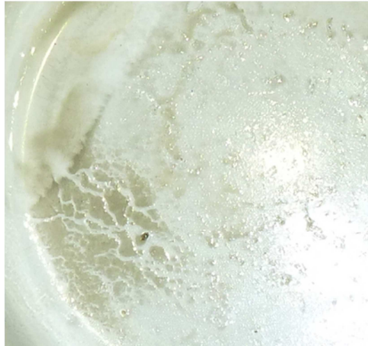
Abbildung 5.6: Bild der abgeschiedenen Ölverunreinigungen
