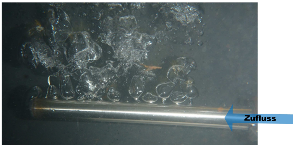
Abbildung 3.15: Aufnahme der Strömungsverteilung entlang der Lanze unter Wasser
